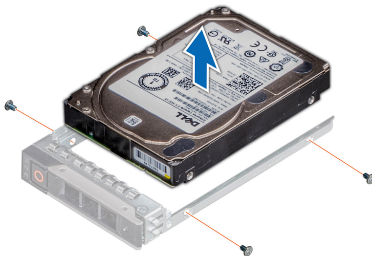
Figure 58. Retrait d'un disque dur installé de son support
