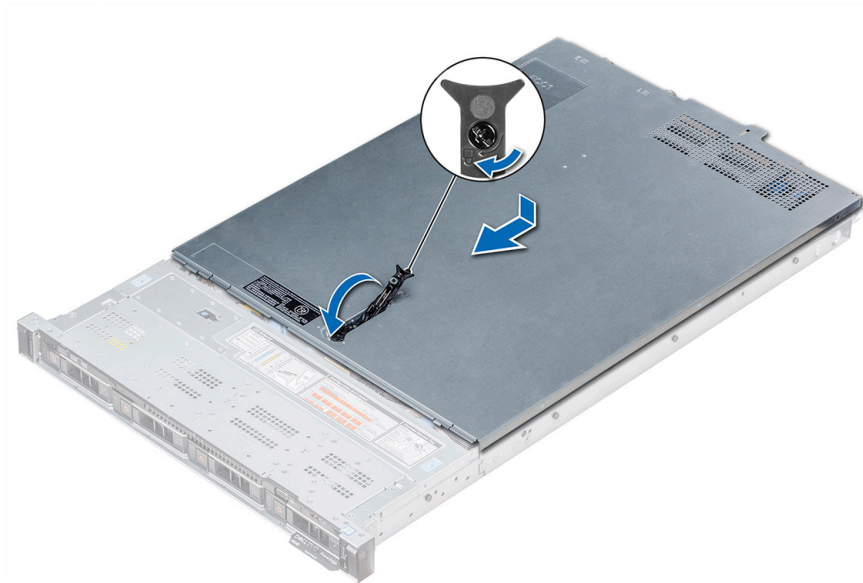
Figure 20. Installation du capot du système
