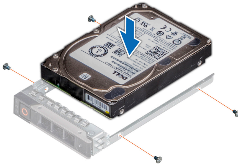
Figure 59. Installation d'un disque dans son support
