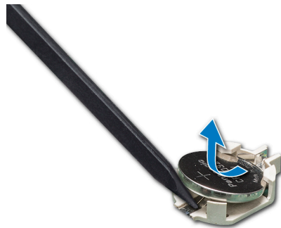
Ilustración 65. Extracción de la batería del sistema
