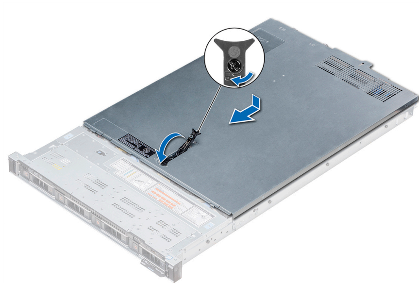
Ilustración 20. Instalación de la cubierta del sistema
