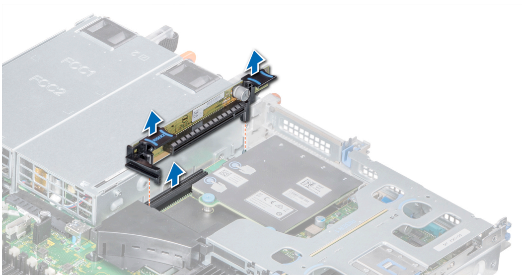
Ilustración 39. Extracción del soporte vertical para tarjetas de expansión 2A
