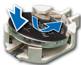
Ilustración 66. Instalación de la batería del sistema
