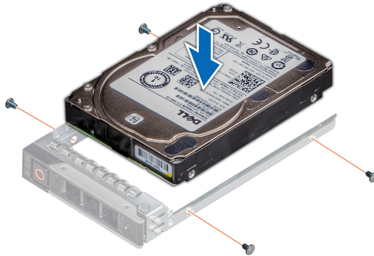
Ilustración 59. Instalación de una unidad en el portaunidades
