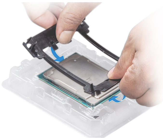
Ilustración 34. Instalación del soporte del procesador
