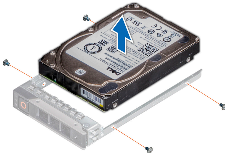
Ilustración 58. Extracción de la unidad del portaunidades
