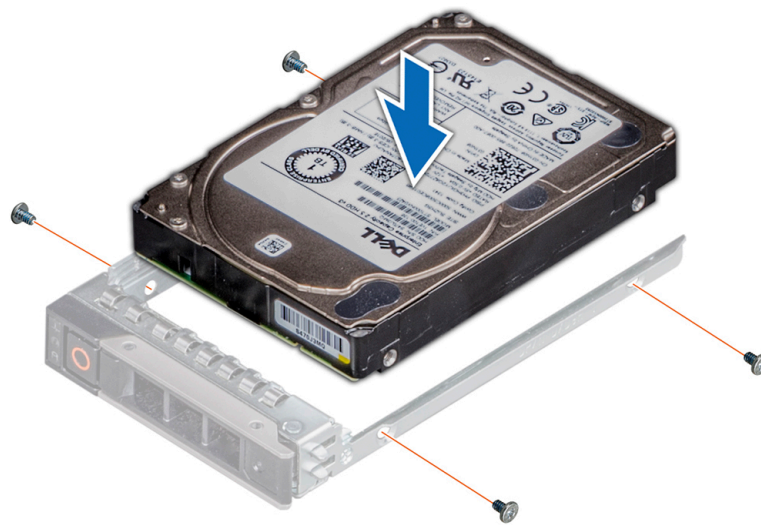
Abbildung 59. Einsetzen eines Laufwerks in einen Laufwerksträger
