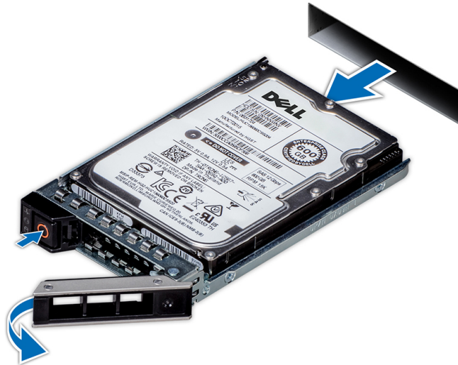
Abbildung 56. Entfernen eines Laufwerksträgers
