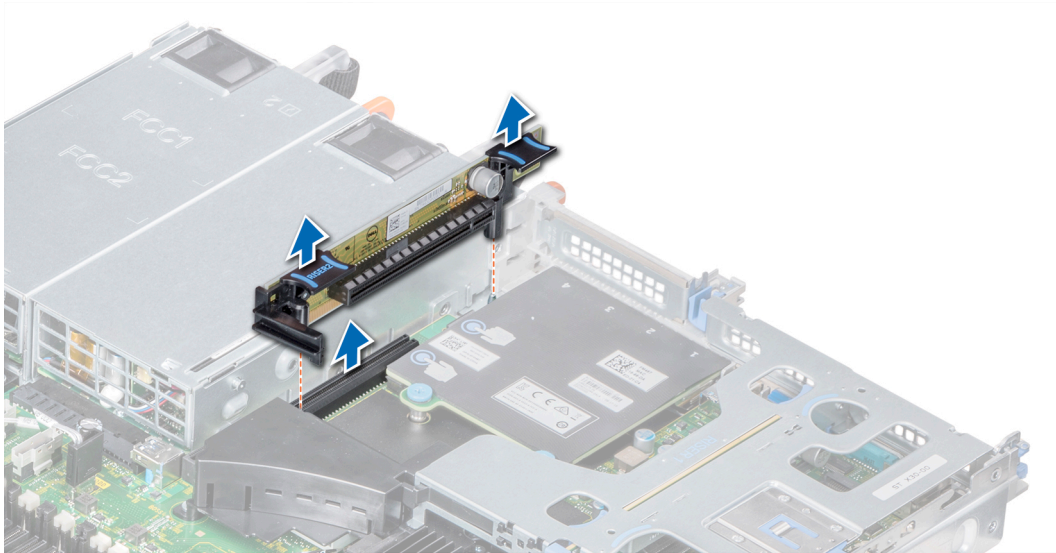
Abbildung 39. Entfernen des Erweiterungskarten-Risers 2A
