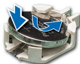
Abbildung 66. Installieren der Systembatterie
