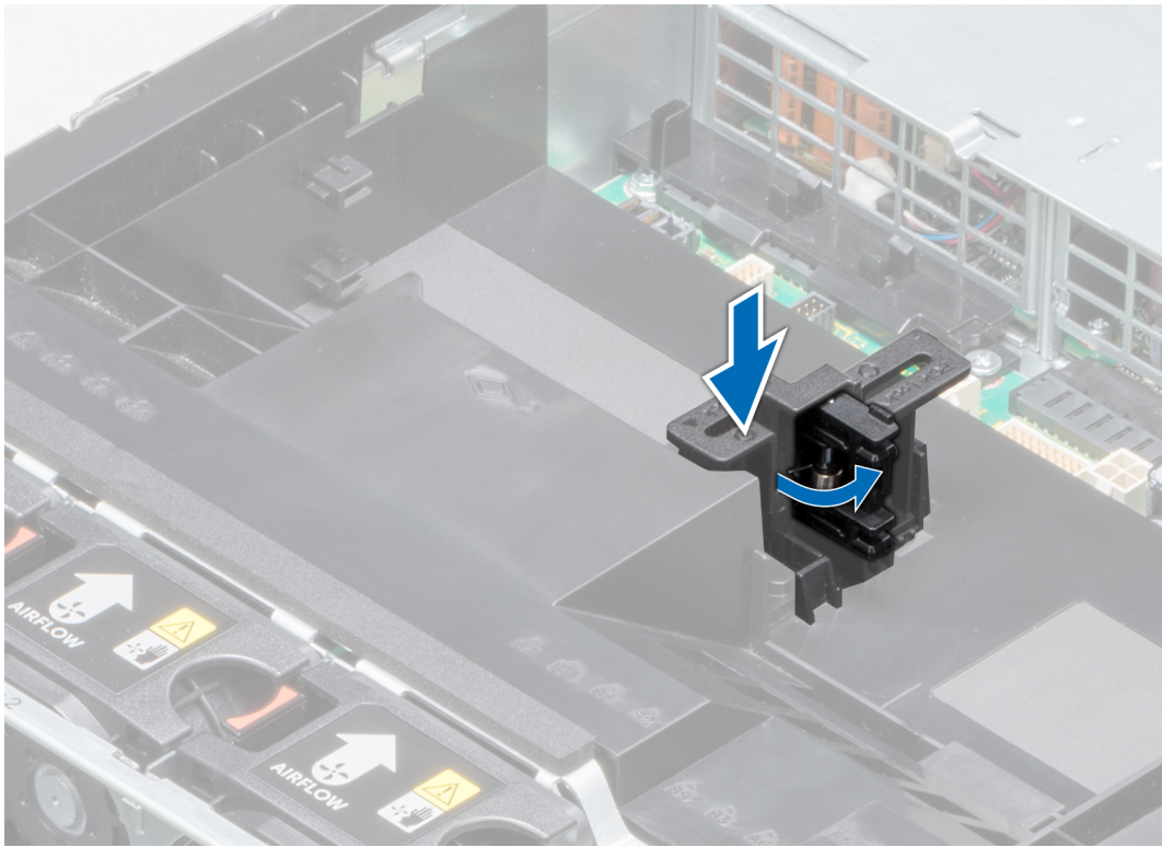
图 54: 打开 PCIe 卡固定器门锁
