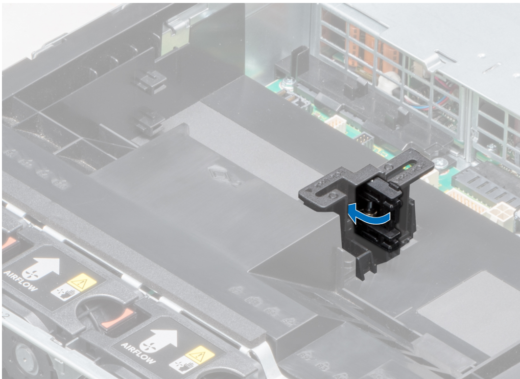
图 55: 关闭 PCIe 卡固定器门锁
