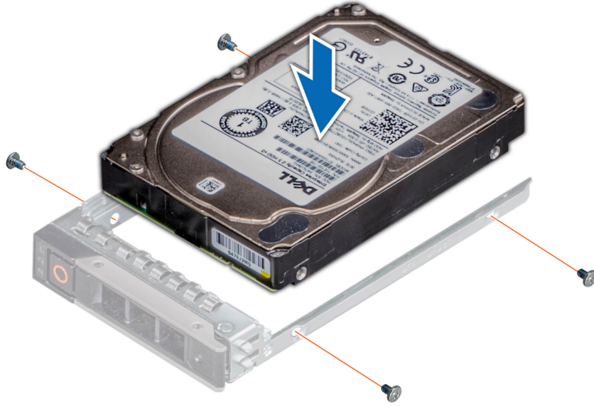
Rakam 41. Sürücü taşıyıcısına bir sürücü takma
