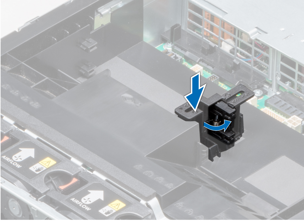
Rakam 54. PCIe kart tutucu mandalını açma
