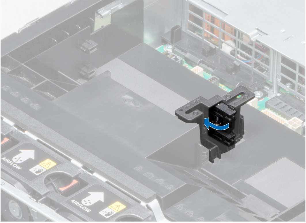
Rakam 55. PCIe kart tutucu mandalının kapatılması
