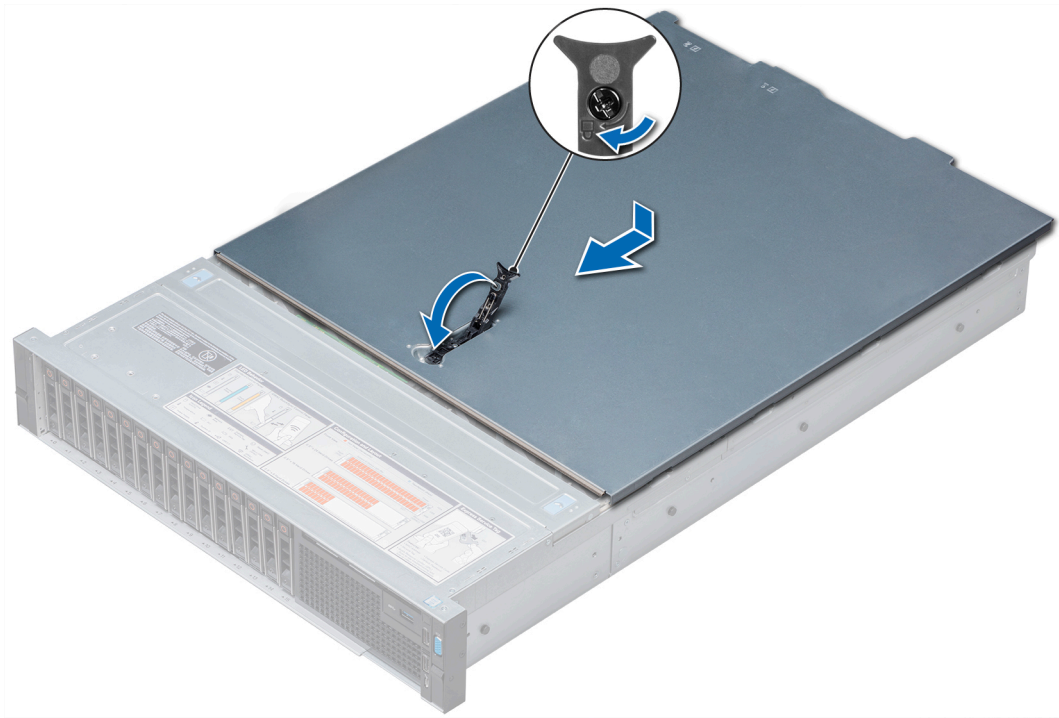
그림 13. 시스템 덮개 장착
