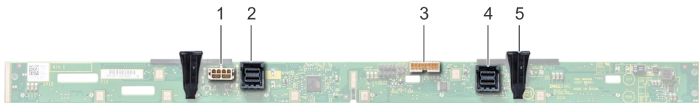
그림 77 . 8.89cm(3.5인치) 백플레인의 후면 모습(중간 드라이브 트레이)
