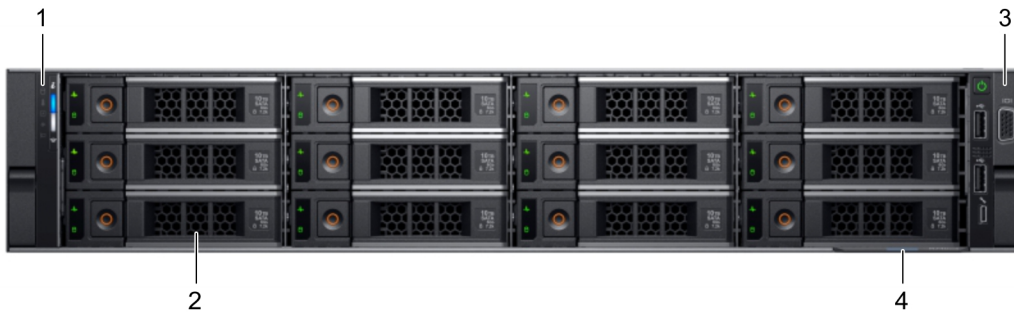
그림 2. 12개의 3.5" 드라이브 시스템의 전면
