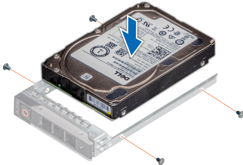
그림 41. 드라이브 캐리어에 드라이브 설치
