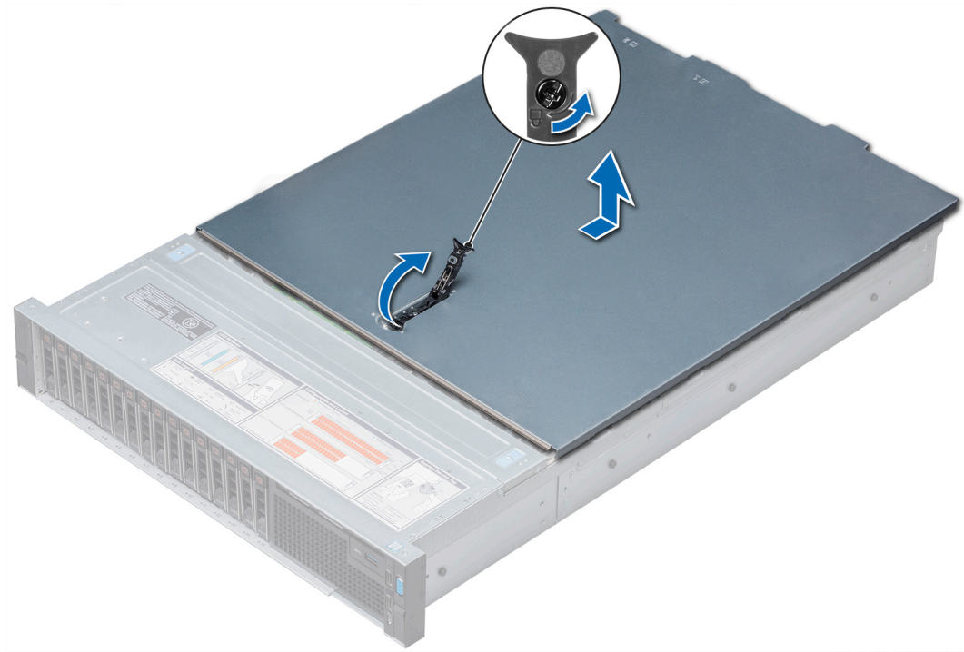
그림 12. 시스템 덮개 분리
