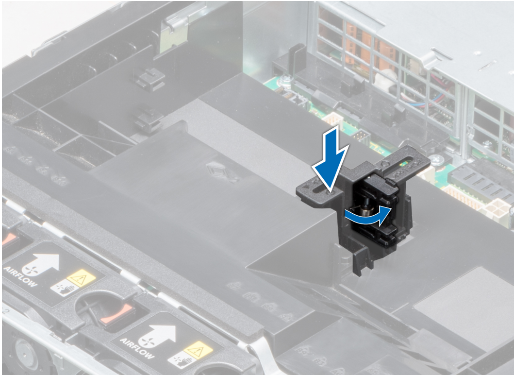
그림 54 . PCIe 카드 홀더 래치 열기
