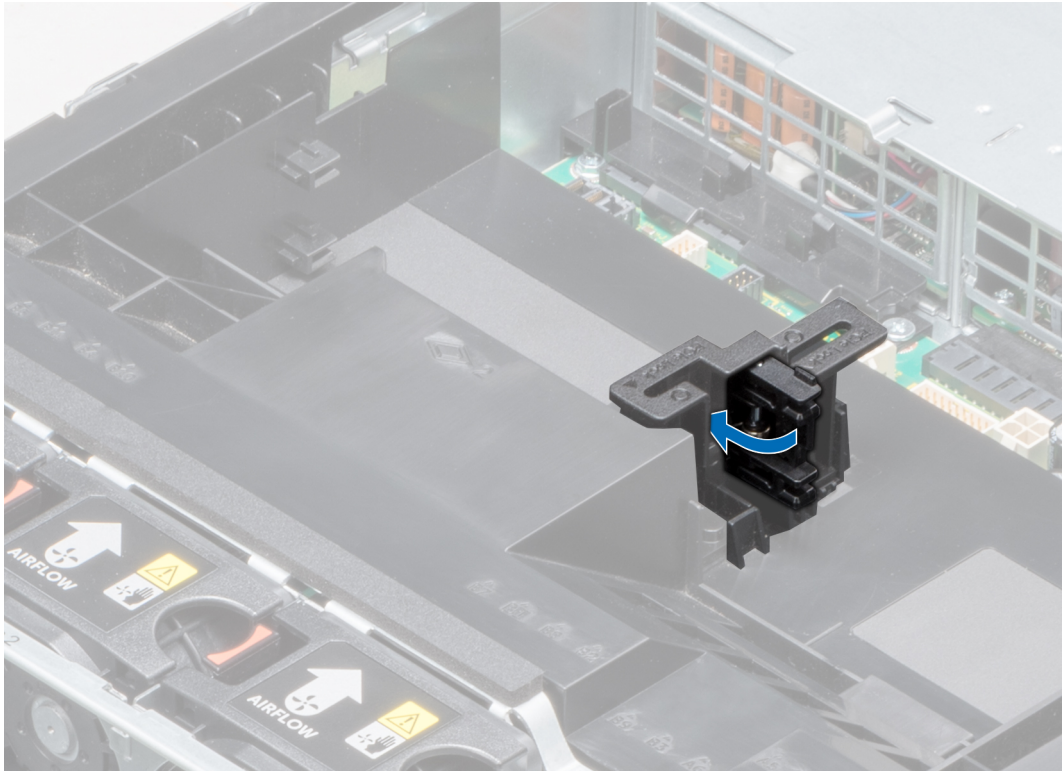
그림 55 . PCIe 카드 홀더 래치 닫기
