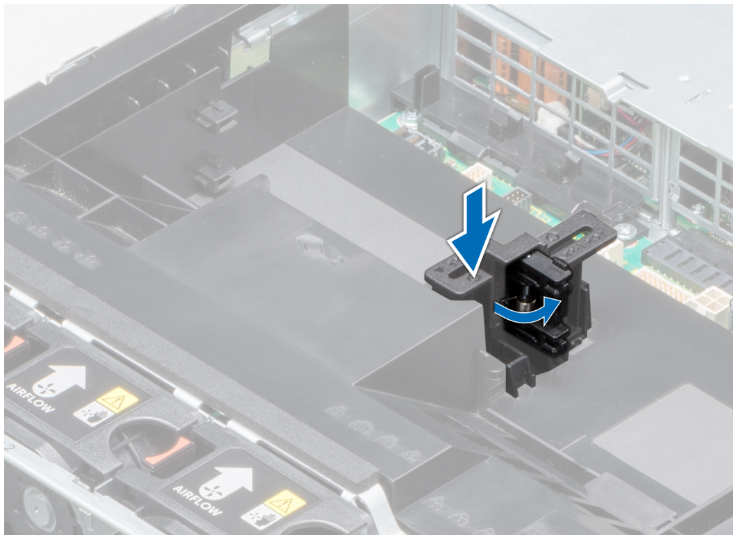
図 54. PCIe カードホルダラッチを開く
