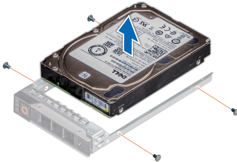
図 40. ドライブ キャリアからのドライブの取り外し
