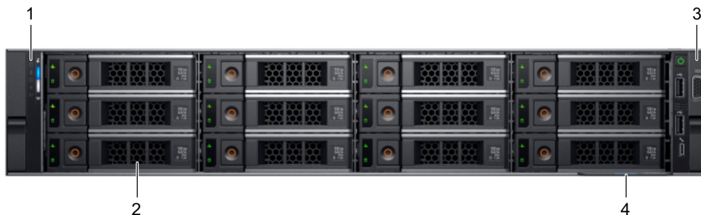
図 2. 12 x 3.5 インチ ドライブ システムの前面図
