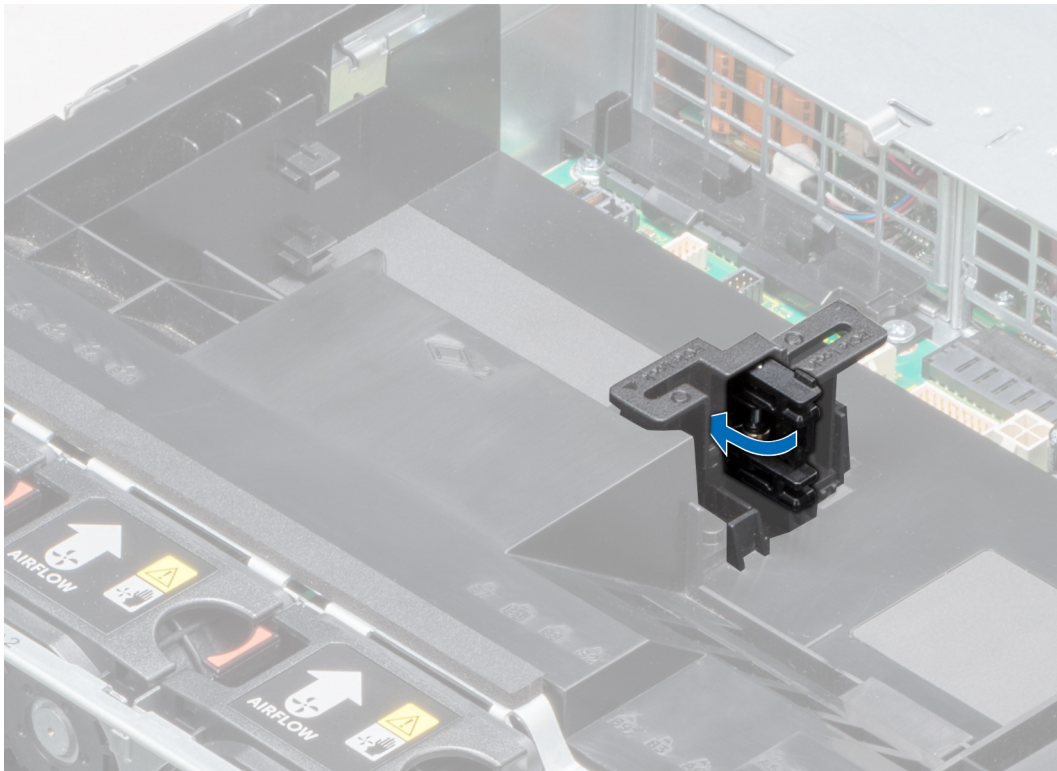
Abbildung 55. Schließen der PCIe-Kartenhalterverriegelung
