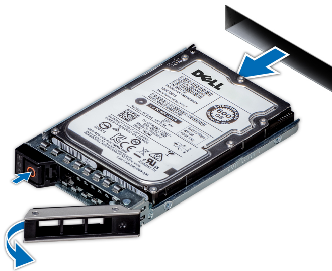
Abbildung 34. Entfernen eines Laufwerksträgers
