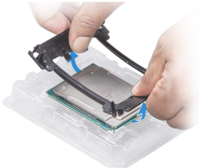
Abbildung 49. Entfernen der Prozessorhalterung
