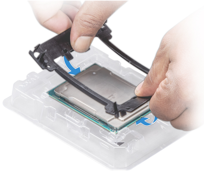
Abbildung 50. Installieren der Prozessor-Halterung
