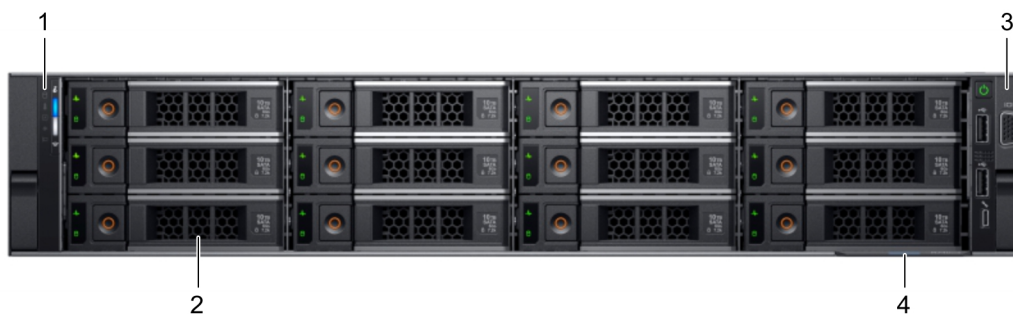
Abbildung 2. Vorderansicht des Systems mit 12 x 3,5-Zoll-Laufwerken
