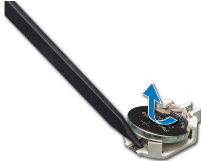
Abbildung 90. Entfernen der Systembatterie
