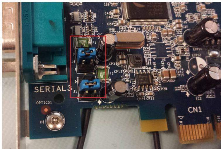
Die serielle Add-in-Karte verfügt über zwei auswählbare Jumper:
