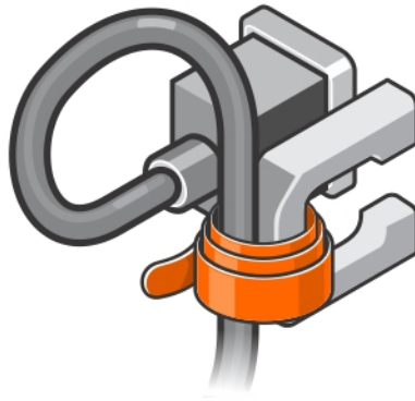
Ilustración 8. Extracción de la tira de velcro del cable de alimentación
