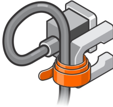
Abbildung 8. Entfernen von Haken und Klettband von dem Stromkabel
