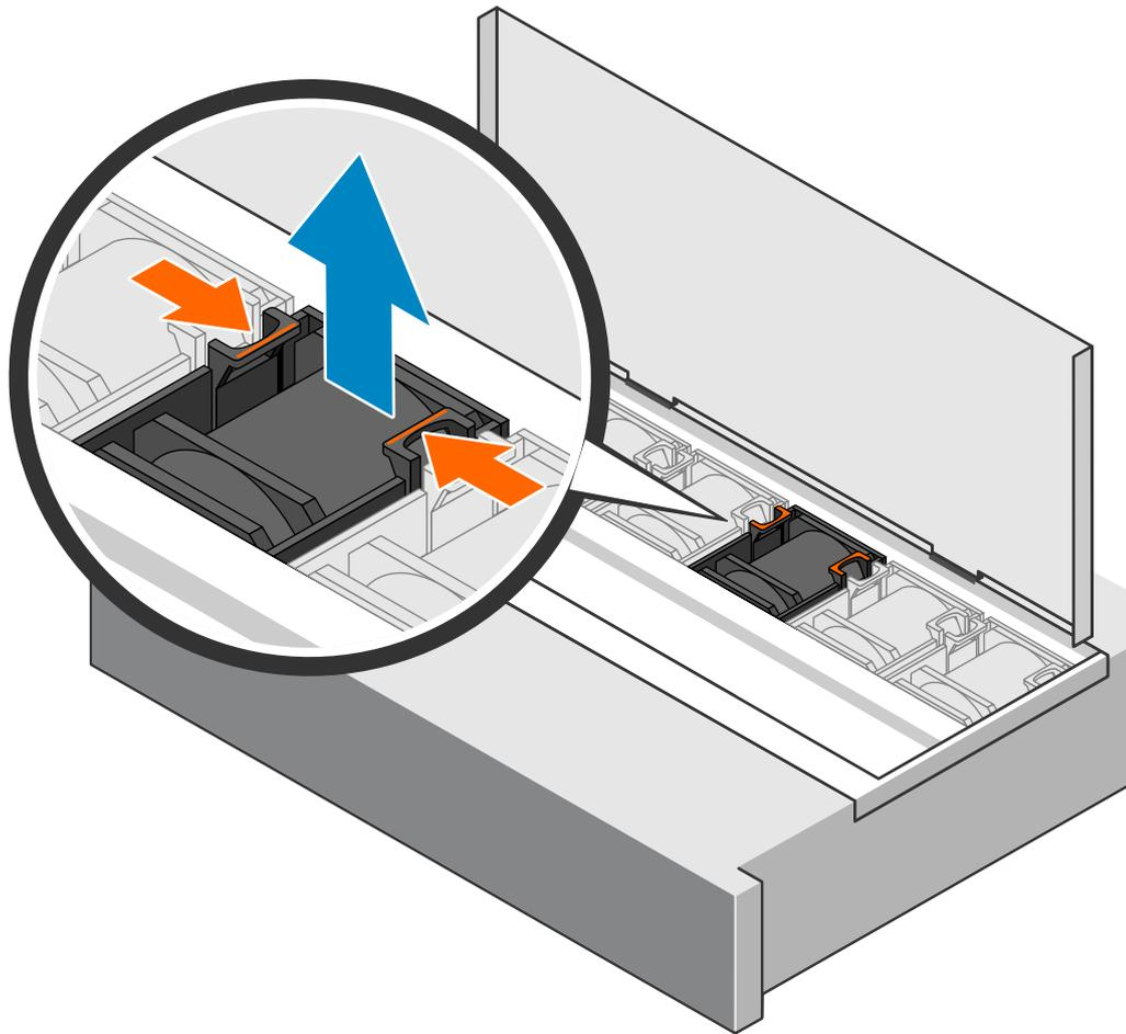
Figure 190. Removing a fan module
