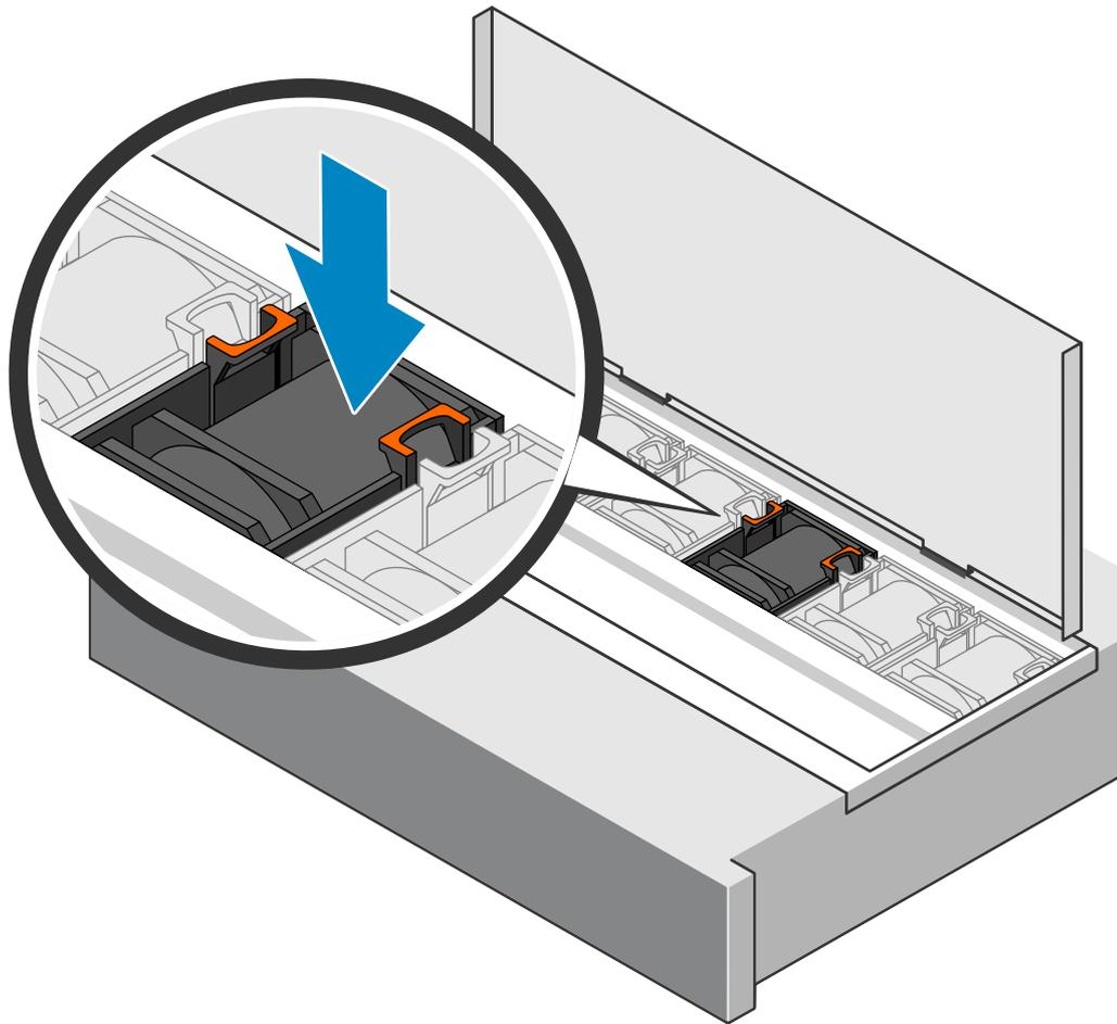
**Figure 191. Installing a fan module**
