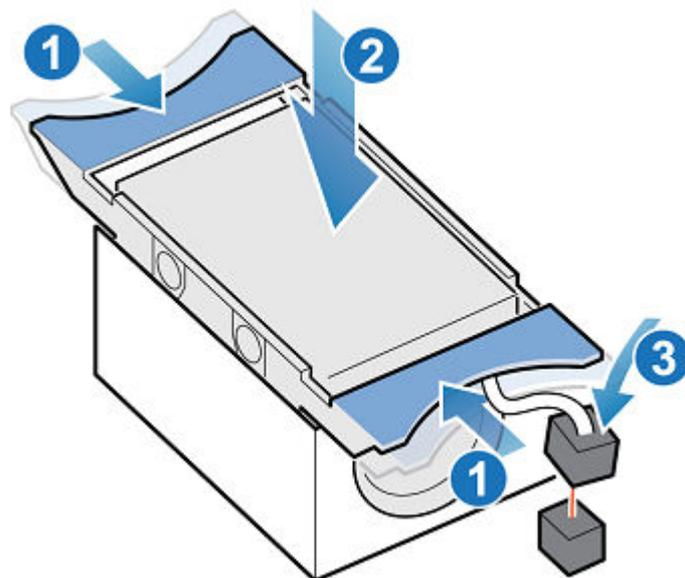
Figure 105. Installing the fan module
