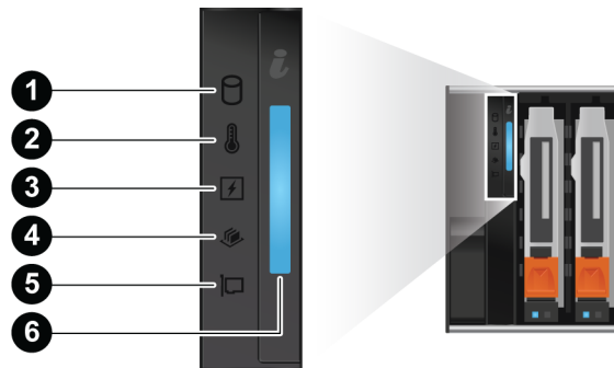
Ilustración 18. LED de estado de la vista frontal del gabinete de expansión NVMe
