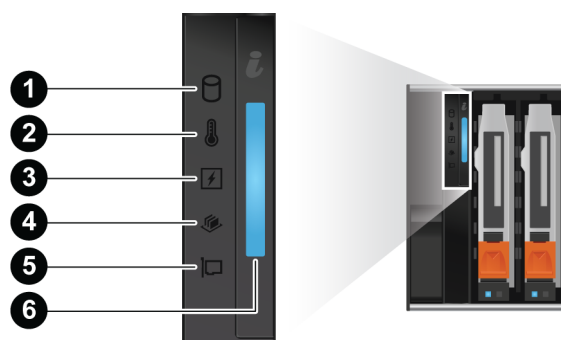
Figure 12. Voyants d'état à l'avant du boîtier d'extension NVMe
