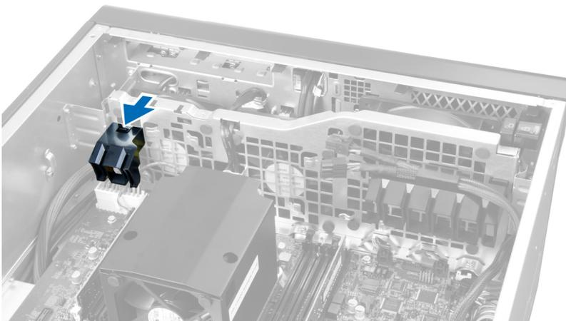
5. Levante a retenção da placa PCIe verticalmente para removê-la do computador.
