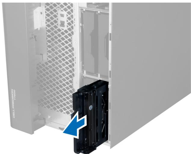
5. Se estiver instalada uma segunda unidade de disco rígido, puxe para fora o gancho do suporte da segunda unidade de disco rígido.
