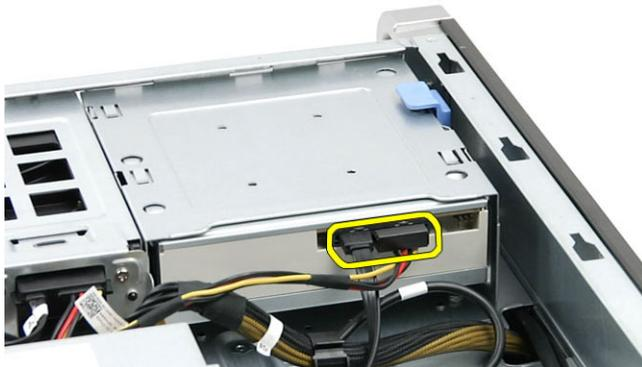
4. Prima a alavanca de libertação e deslize a unidade óptica para fora, para libertá-la do compartimento da unidade [1, 2].
