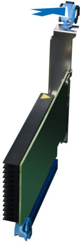
4. Empurre o trinco para baixo e puxe a placa PCI afastando-a do computador.
