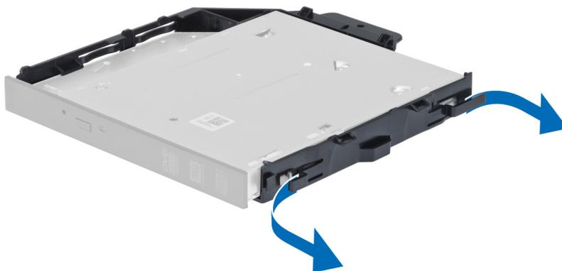
8. Levante a unidade óptica e retire-a do suporte.
