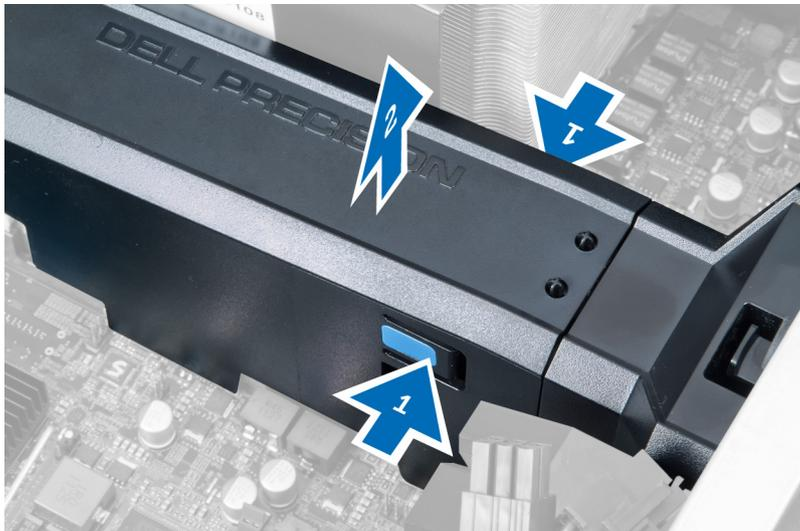
4. Prima o trinco de desbloqueio na outra extremidade do módulo da cobertura de memória para o soltar do chassi.
