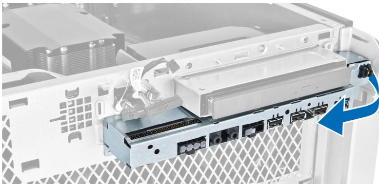
6. Faça deslizar a extremidade oposta do conjunto do painel de E/S para fora para desengatar o conjunto de E/S do chassis.
