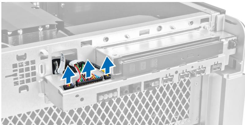
4. Retire os parafusos que fixam o conjunto do painel de E/S no chassis do computador.
