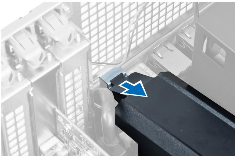
5. Prima o trinco de desbloqueio na base da cobertura da memória e levante-o para retirá-lo do computador.
