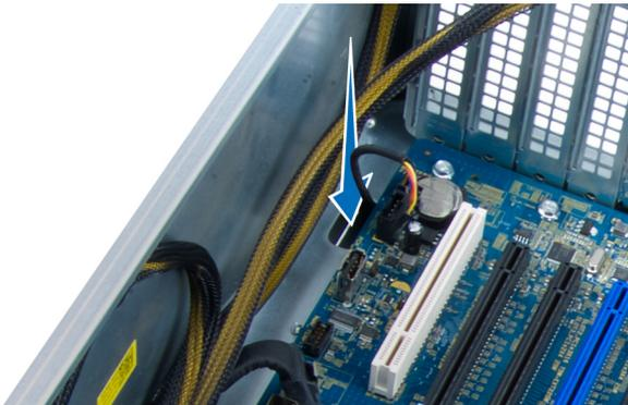
5. Retire os parafusos que fixam a ventoinha da unidade de disco rígido no chassis do computador e retire a ventoinha do computador.
