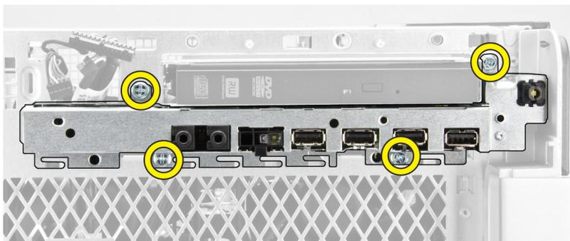
5. Puxe o conjunto do painel de E/S na direcção oposta ao computador para soltar a respectiva extremidade do grampo no chassis.
