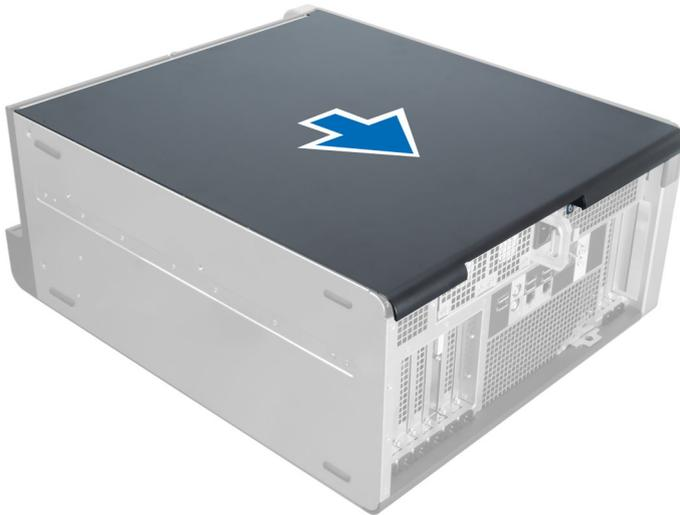
4. Levante a tampa da direita num ângulo de 45 graus e retire-a do computador.
