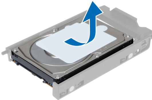
9. Se estiver instalada uma unidade de disco rígido de 2,5 polegadas, empurre os grampos de fixação para fora e levante a unidade para a retirar do compartimento da unidade de disco rígido de 3,5 polegadas.
