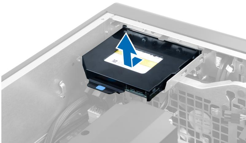
7. Flexione as travas do suporte da unidade óptica para fora para soltar a unidade óptica do suporte.
