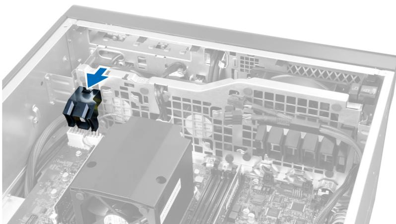
5. Lixe a retenção da placa PCIe em uma direção vertical para removê-la do computador.
