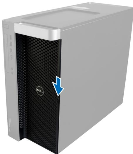
3. Mantenha a trava pressionada para baixo e puxe a tampa da frente para fora para removê-la do computador.
