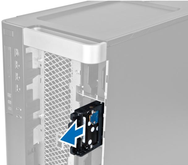
7. Flexione o suporte do disco rígido nas laterais para soltar o disco rígido.
