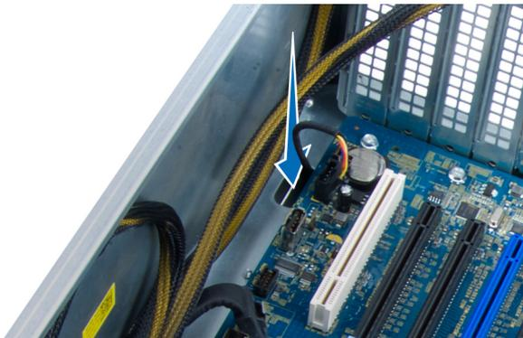
5. Remova os parafusos que prendem o ventilador da unidade de disco rígido no chassi do computador e remova o ventilador do computador.
