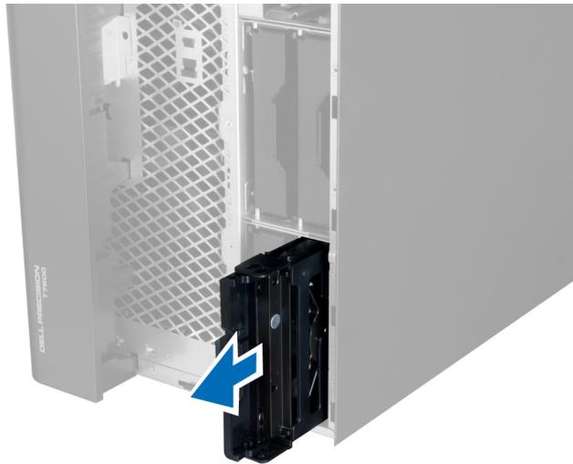
5. Se há um segundo disco rígido instalado, puxe o fecho do suporte do segundo disco rígido para fora.
