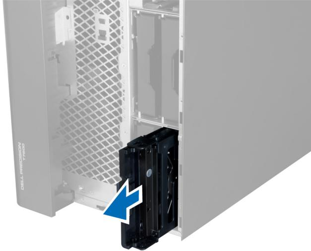
5. Si un second disque dur est installé, tirez le fermoir du support du second disque dur vers l'extérieur.
