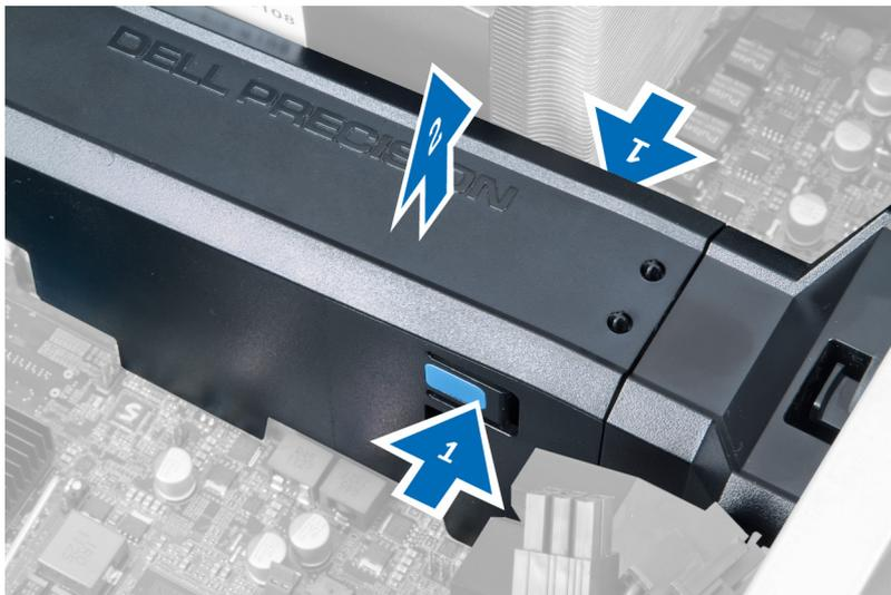
4. Appuyez sur le loquet de libération de l'autre côté du module du carénage de la mémoire pour le libérer du châssis.
