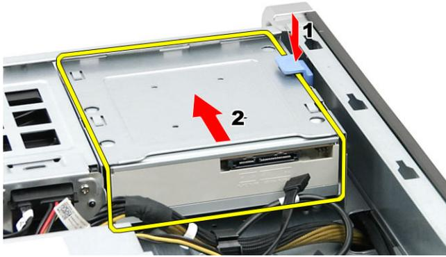
5. Déposez les vis du lecteur optique et déposez le support.
