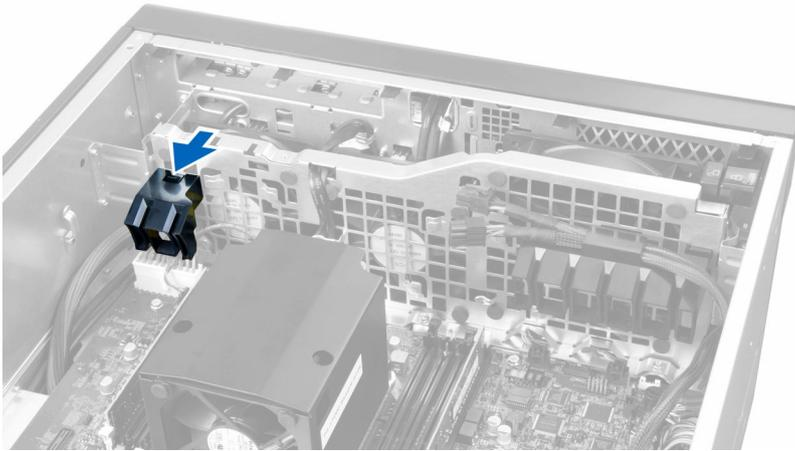
5. Heben Sie den PCIe-Kartenhalter nach oben, um ihn aus dem Computer zu entfernen.
