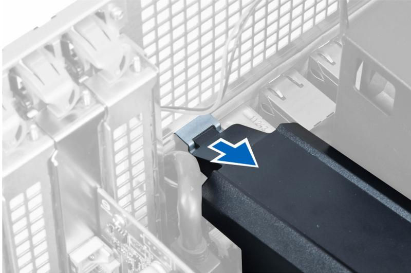
5. Drücken Sie den Entriegelungsriegel auf dem Speichergehäusesockel nach unten und heben Sie ihn nach oben, um ihn aus dem Computer zu entfernen.
