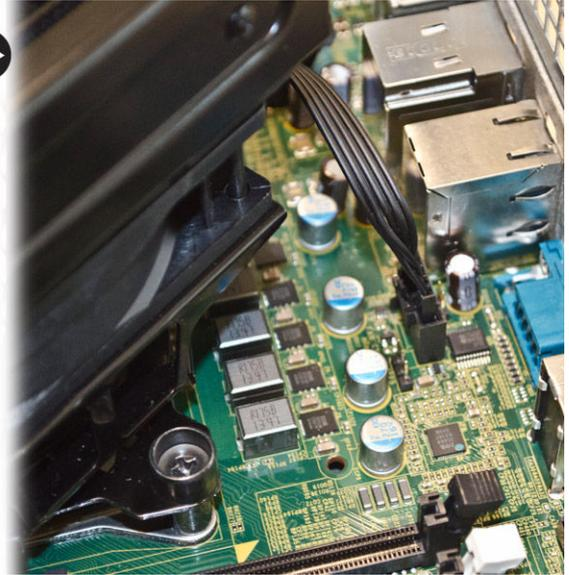
5. Drücken Sie fest auf den Kühlkörper und drehen Sie ihn im Uhrzeigersinn.
