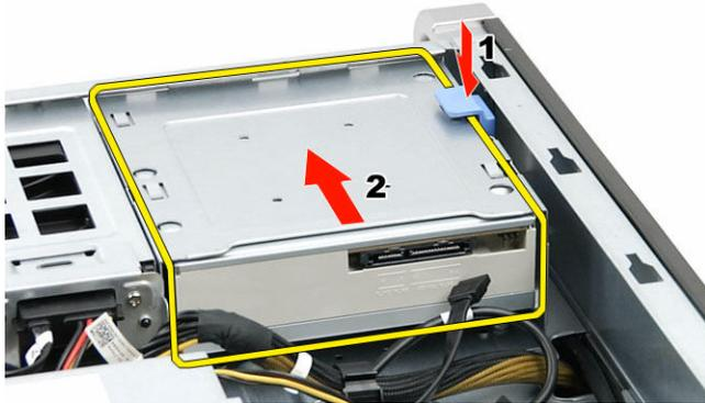
5. Lösen Sie die Schrauben vom optischen Laufwerk und entfernen Sie die Laufwerkhalterung.
