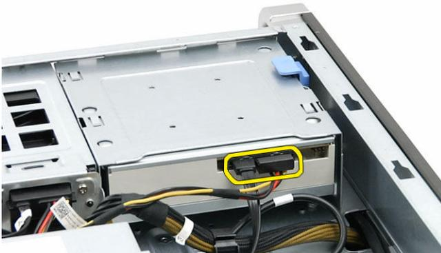
4. Drücken Sie auf den Entriegelungsriegel und schieben Sie das optische Laufwerk heraus, um es aus dem Laufwerkschacht zu lösen [1, 2].
