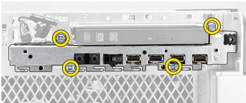
5. Ziehen Sie die E/A-Leistenbaugruppe in die dem Computer entgegengesetzte Richtung, um ihre Kante aus der Gehäuseklammer zu lösen.
