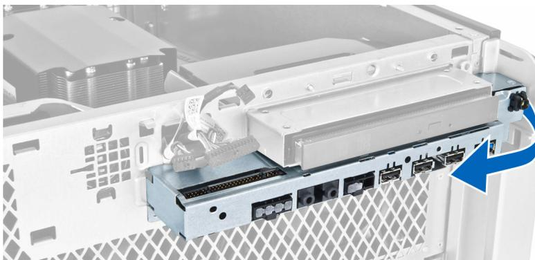
6. Schieben Sie die gegenüberliegende Seite der E/A-Leistenbaugruppe nach außen, um das E/A-Baugruppe aus dem Gehäuse zu lösen.
