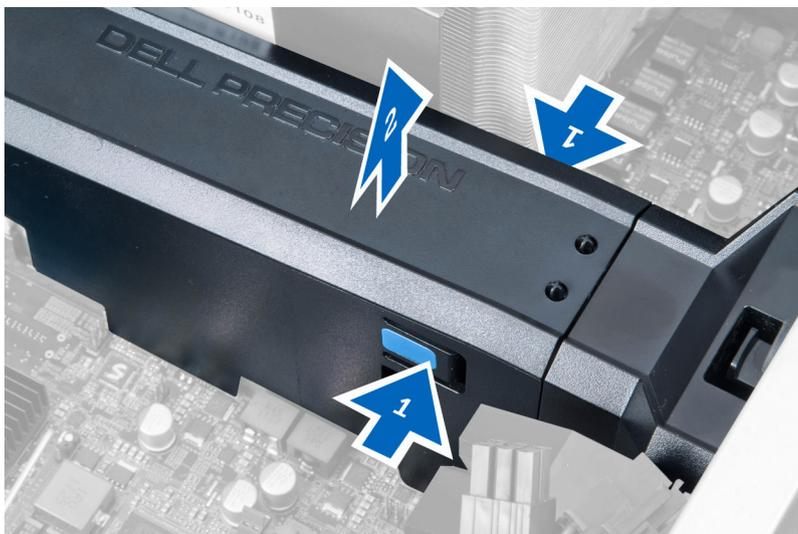
4. Drücken Sie auf den Entriegelungsriegel auf der anderen Seite des Speichergehäusemoduls, um es aus dem Gehäuse zu lösen.
