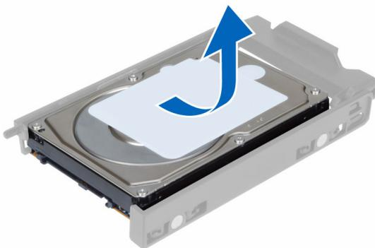
9. Falls eine 2,5-Zoll-Festplatte installiert ist, drücken Sie die Halteklammern nach außen und heben Sie das Laufwerk nach oben aus der 3,5-Zoll-Festplattenlaufwerkhalterung heraus.
