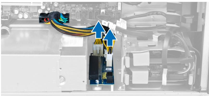
6. 拧下用于将 PSU 卡固定至插槽的螺钉。
