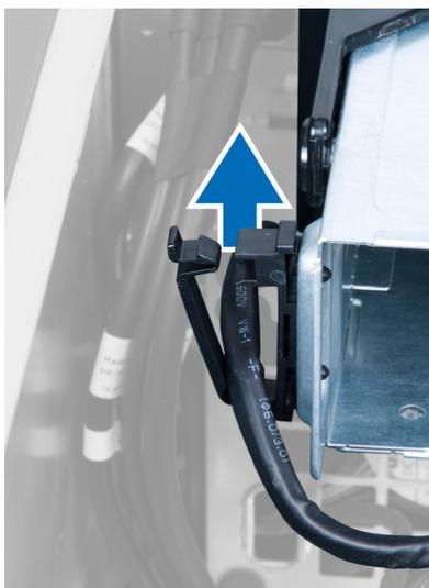
7. 提起光盘驱动器固定框架顶部的释放门锁。
