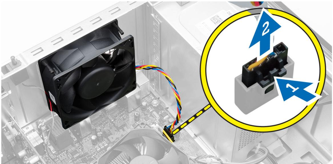
4. Faites levier pour dégager le ventilateur système des quatre passe-câbles qui le maintiennent à l'arrière de l'ordinateur.
