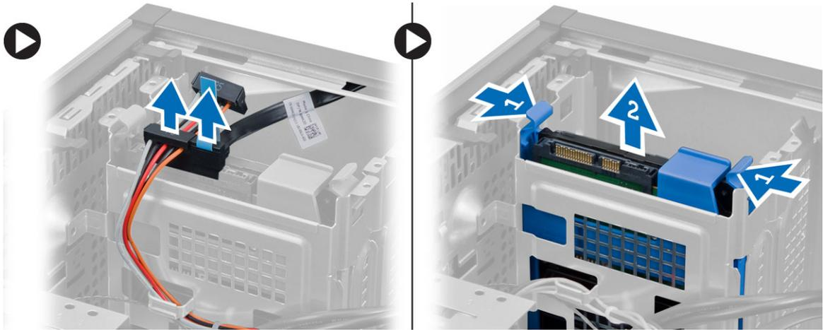
4. Courbez le support du disque dur et retirez le disque dur du support.
