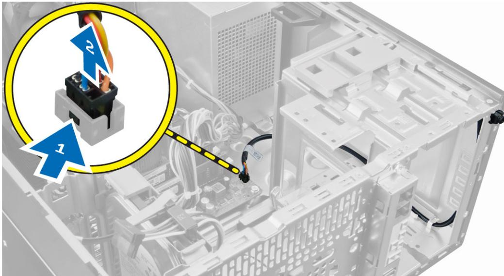
4. Retirez le câble de l'interrupteur d'alimentation des clips du châssis.
