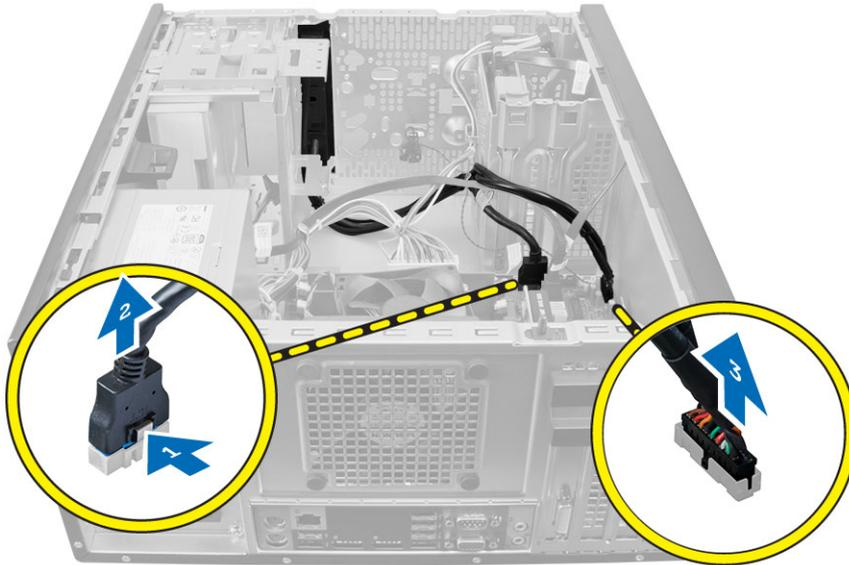
4. Dégagez et retirez le panneau d'E/S, le câble de données et le câble de données USB de son clip de fixation de l'ordinateur.
