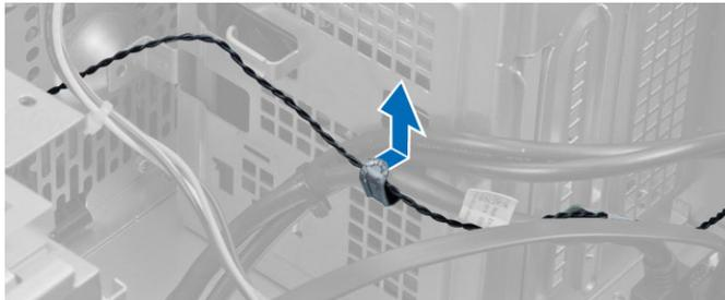
5. Drücken Sie von beiden Seiten auf die Laschen, um den Temperatursensor zu lösen und aus dem Gehäuse zu entfernen.
