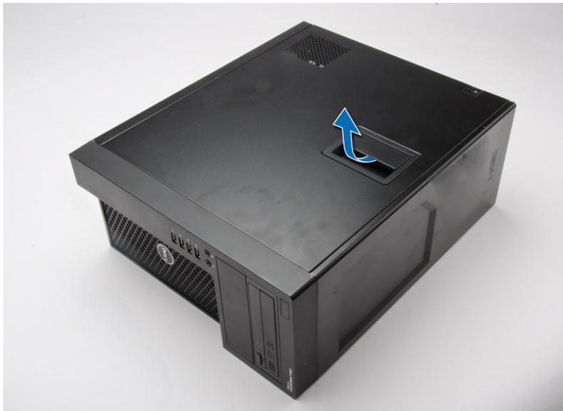
3. Heben Sie die Abdeckung hoch, um sie vom Computer zu entfernen.
