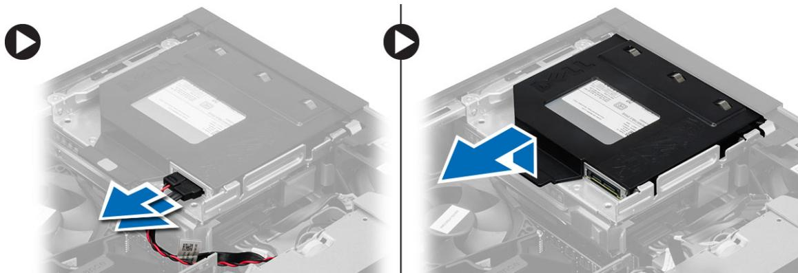
5. 弯曲光盘驱动器支架，然后将光盘驱动器提离支架
