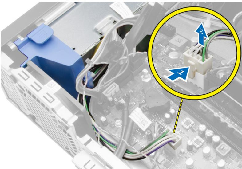
4. 断开 4 针电源电缆与系统板的连接。
