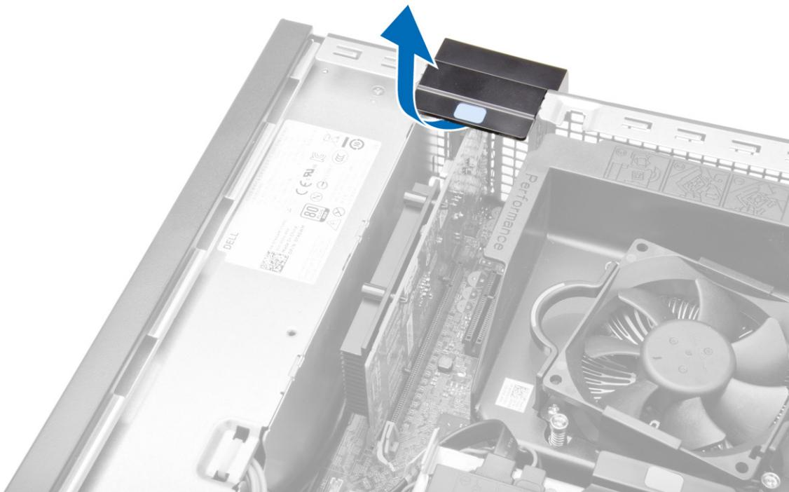
4. 将释放拉杆拉离扩充卡，直到将固定卡舌从插卡凹槽中释放出来。然后，从其连接器中提起插卡并将其从计算机中卸下。
