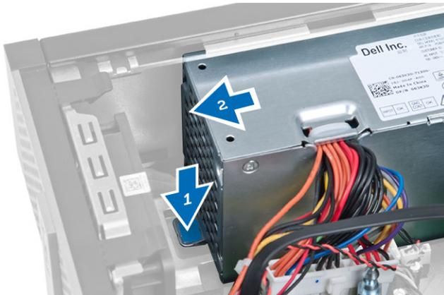
7. Levante a fonte de alimentação e retire-a do computador
