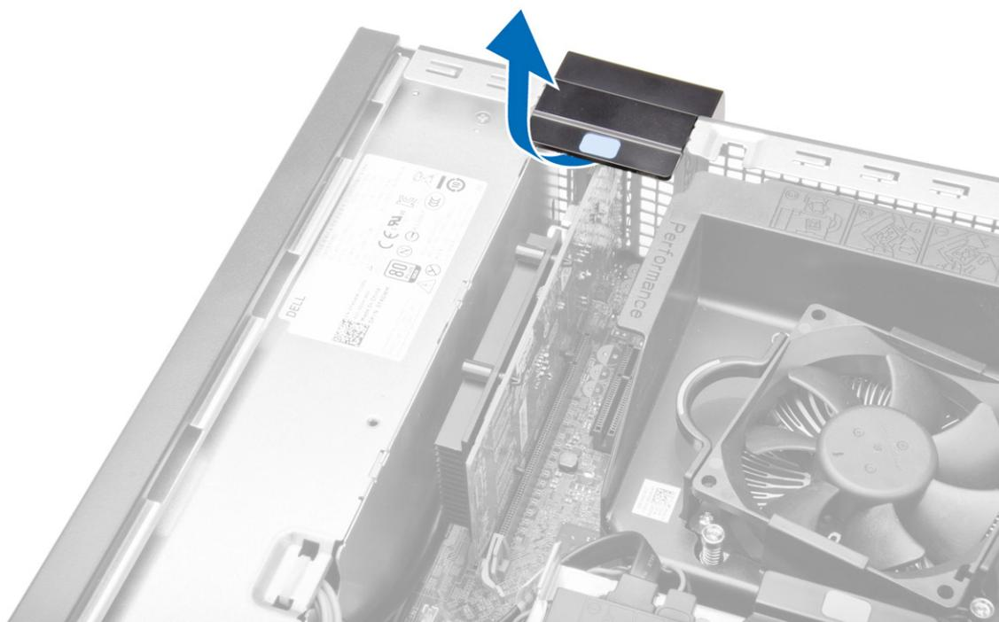
4. Afaste a alavanca de desbloqueio da placa de expansão até soltar a patilha de fixação do entalhe na placa. Em seguida, liberte a placa do respectivo conector e retire-a do computador.
