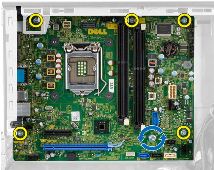
6. Retire a placa de sistema do chassis.
