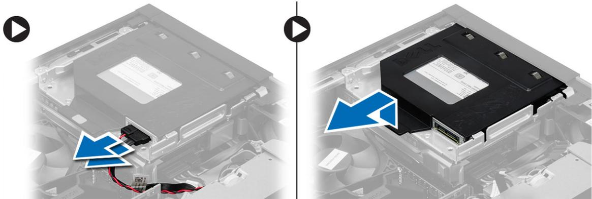
5. Flexione o suporte da unidade óptica e, em seguida, remova-a do suporte.
