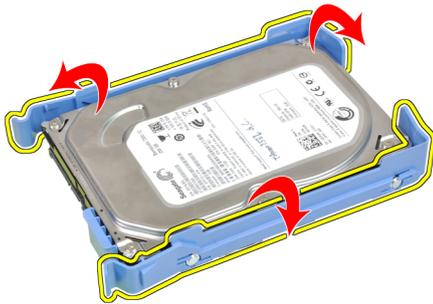
5. Remova os parafusos que fixam o mini disco rígido ao suporte da unidade de disco rígido e remova o disco rígido de seu suporte.
