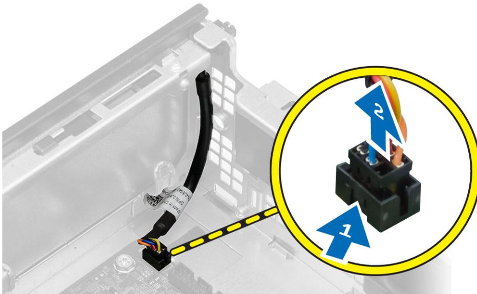
4. Pressione os cliques em ambos os lados da chave liga/desliga para liberá-la do chassi e retire a chave liga/desliga do computador.
