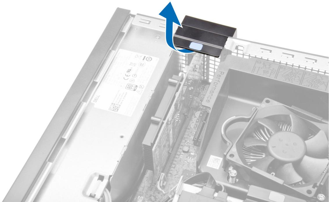
4. Afaste a alavanca de liberação da placa de expansão até soltar a aba de fixação do entalhe na placa. Em seguida, solte a placa de seu conector e remova-a do computador.
