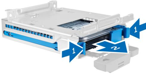
4. Flexione o suporte do disco rígido e remova o disco rígido do suporte.
