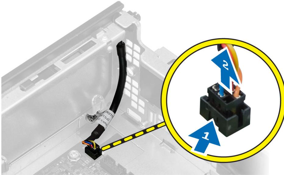
4. Premere i fermagli su entrambi i lati dell'interruttore di alimentazione per rilasciarlo dal telaio e rimuovere l'interruttore di alimentazione e il suo cavo dal computer.
