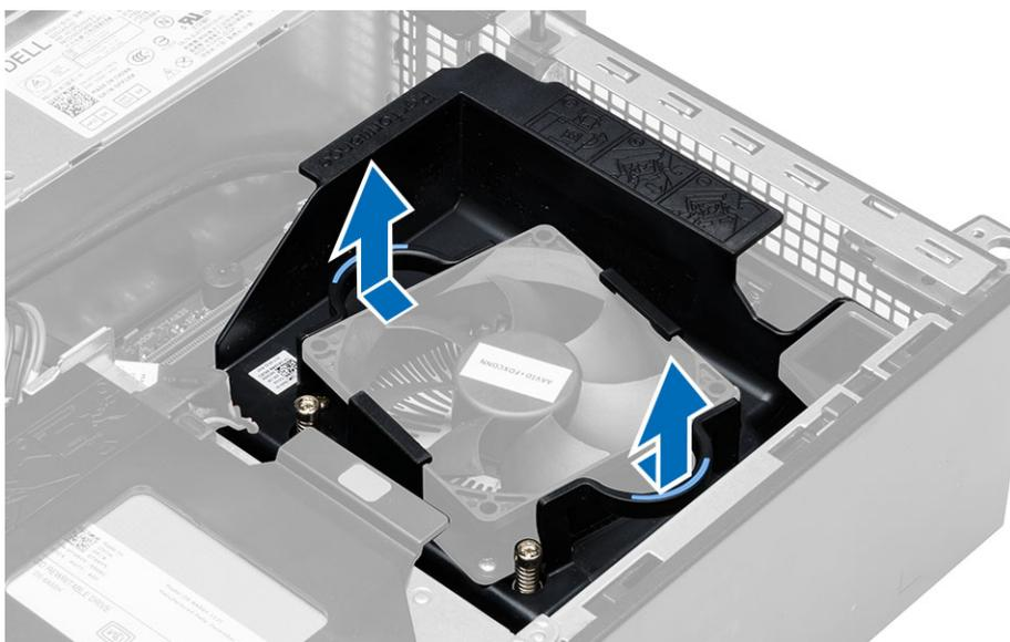
4. Scollegare il cavo della ventola dalla scheda di sistema. Allentare le viti di fissaggio, sollevare il gruppo dissipatore di calore al computer e rimuoverlo.
