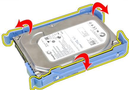
5. Rimuovere le viti che fissano il mini disco rigido al supporto e rimuovere il disco rigido dal relativo supporto.
