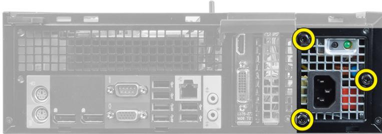
6. Premere la linguetta di sbloccaggio blu sui lati dell'alimentatore e fare scorrere l'alimentatore verso la parte anteriore del computer.
