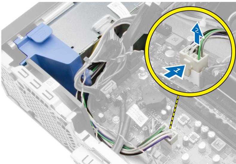
4. Desconecte los cables de alimentación de 4 patas de la placa base.
