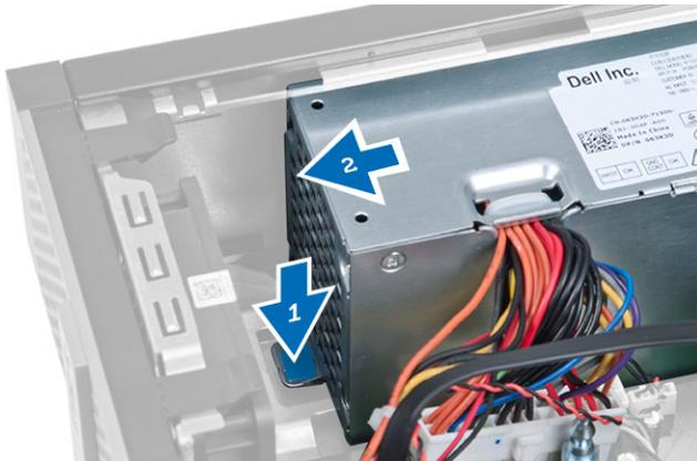
7. Levante y retire el suministro de energía del equipo.
