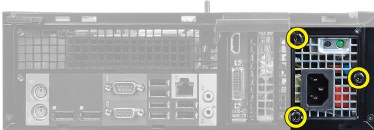
6. Empuje el pestillo de liberación azul al lado de la fuente de alimentación y deslice la fuente de alimentación hacia la parte frontal del equipo.
