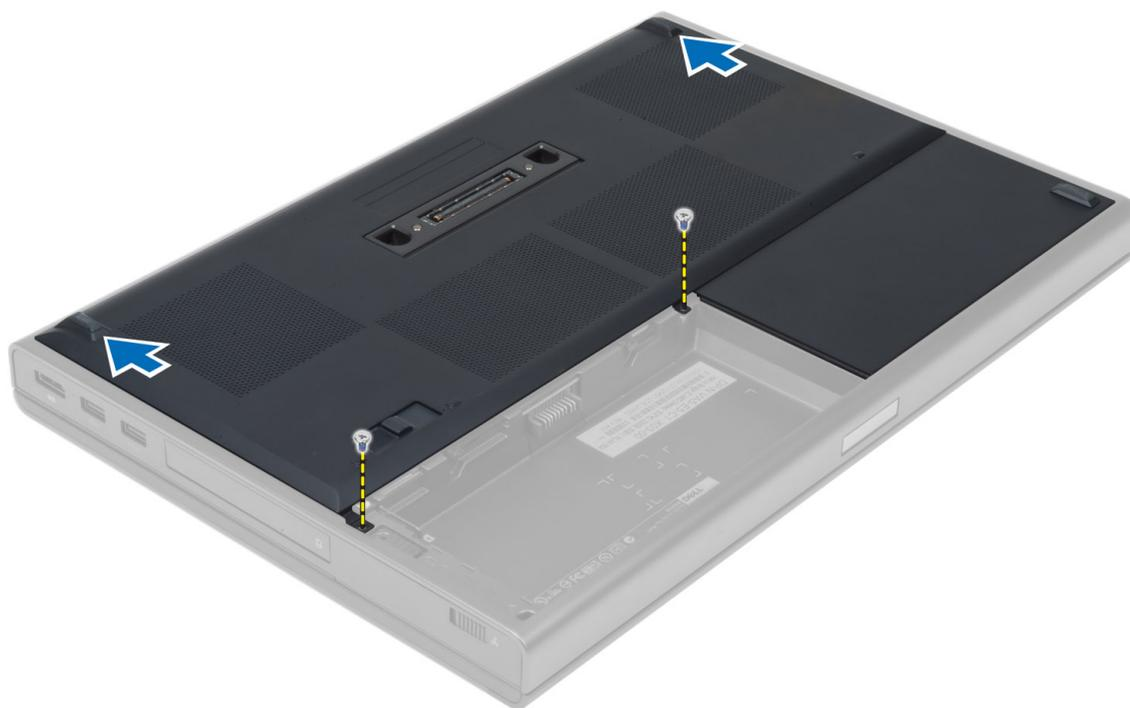
4. Levante e retire a tampa da base do computador.
