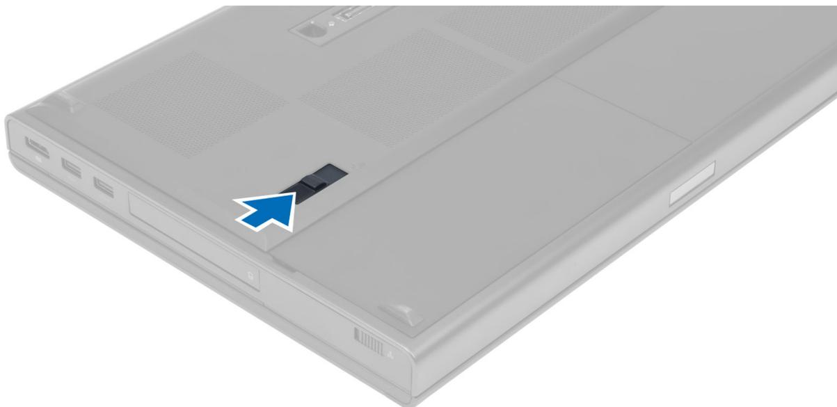
3. Levante e retire a bateria do computador.
