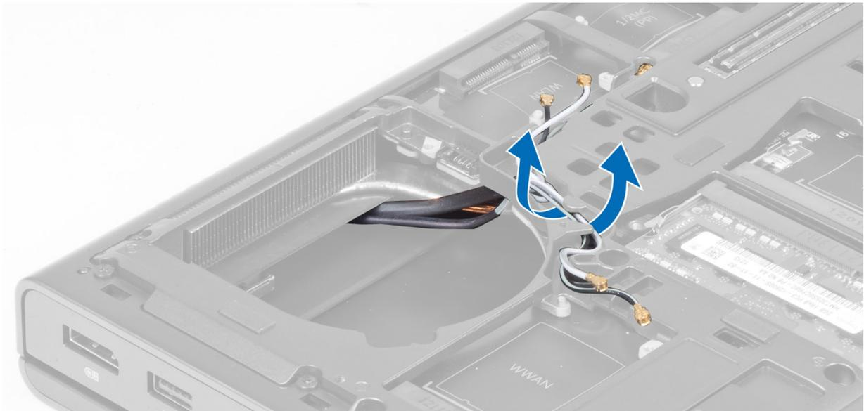
4. Retire os cabos das antenas dos canais de encaminhamento.
