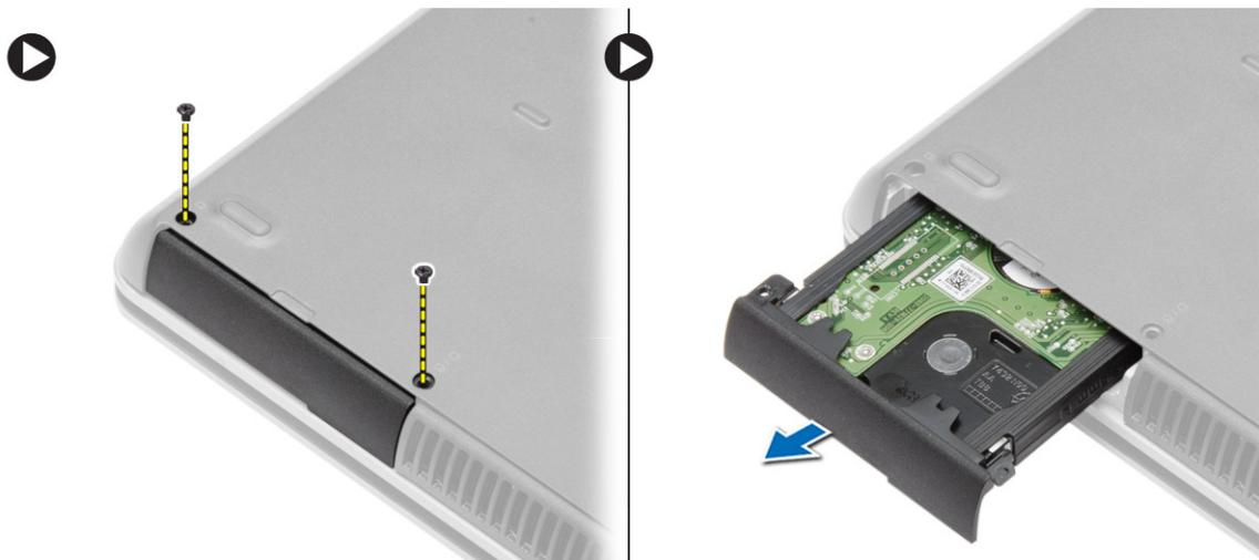
4. Entfernen Sie die Schraube, mit der die Festplattenlaufwerkhalterung am Festplattenlaufwerk befestigt ist. Ziehen Sie die Festplattenlaufwerkhalterung von der Festplatte.
