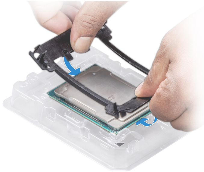
Figura 17. Installazione della staffa del processore
