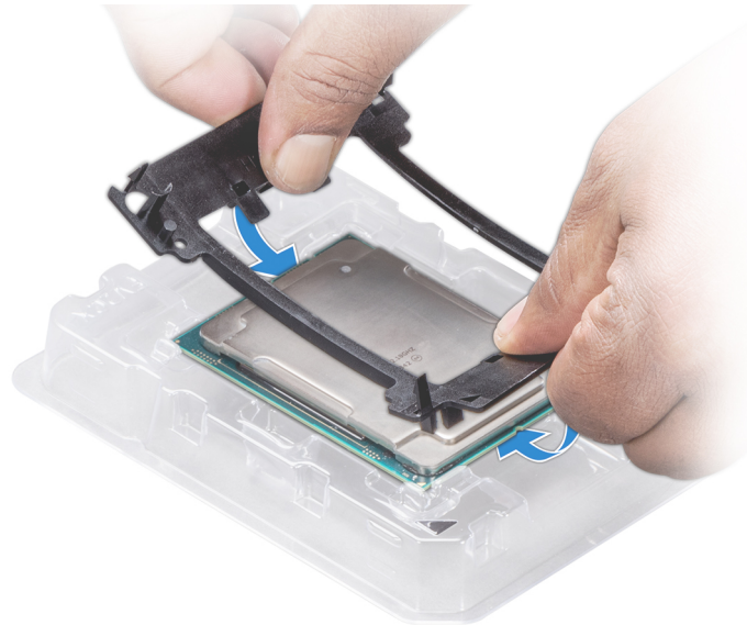
Abbildung 17. Installieren der Prozessor-Halterung
