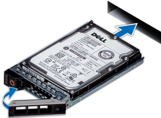
Abbildung 14. Installieren des Festplattenlaufwerks
