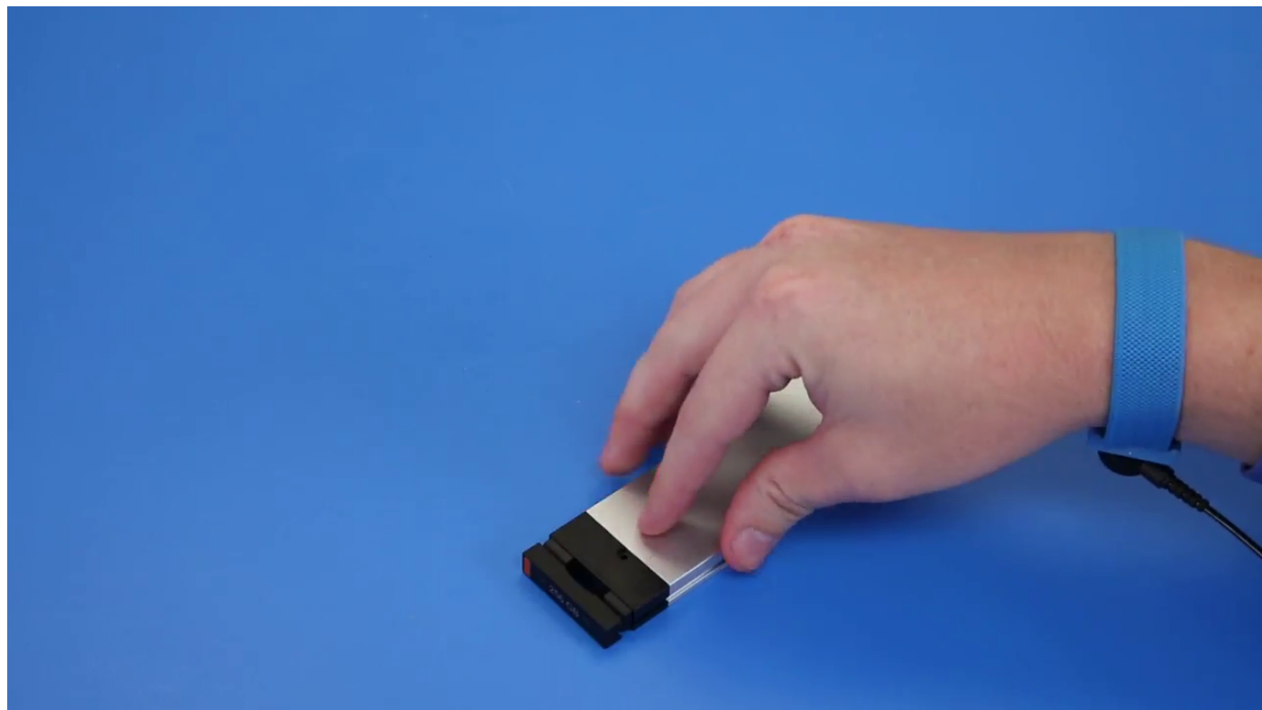
d. قم بإزاحة محرك أقراص مزود بذاكرة مصنوعة من مكونات صلبة (SSD) إلى خارج فتحة M.2 الموجودة في الحامل.
