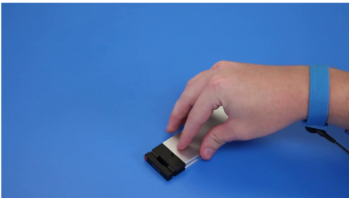
d) Vysuňte disk SSD zo slotu M.2 v držiaku.
