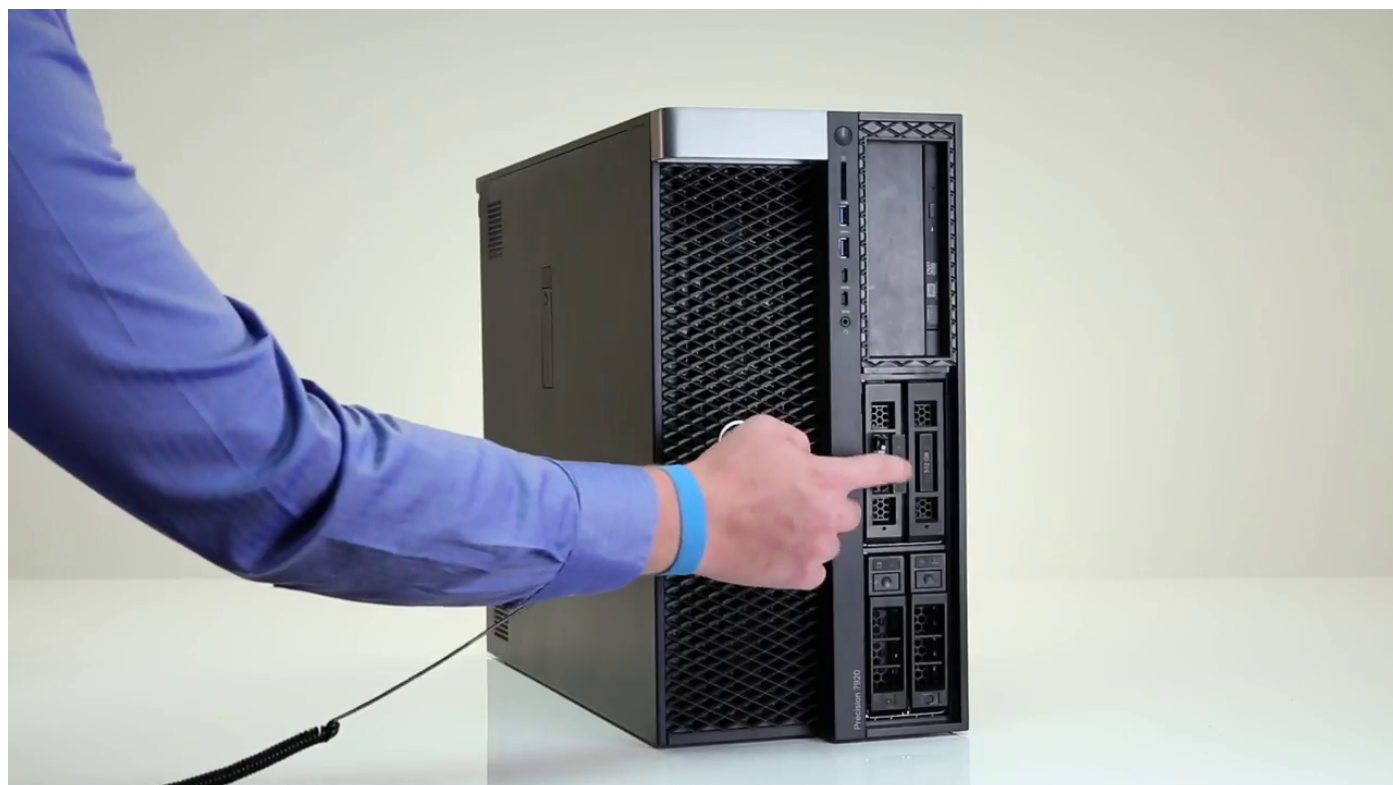
(b) משוך את נשא כונן ה-SSD מסוג M.2 אל מחוץ לתא הגמיש של ה-NVMe.
