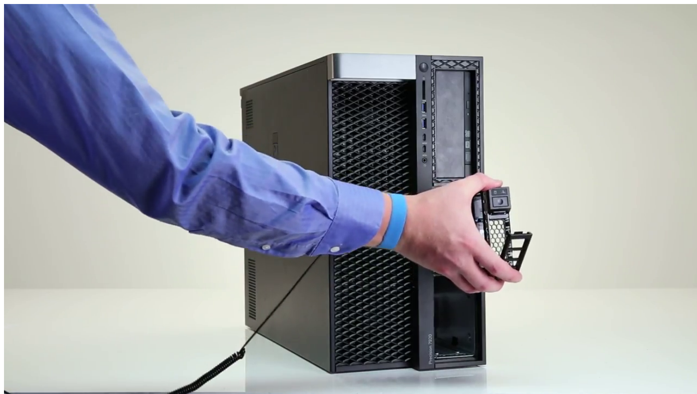
4. כדי להסיר נשא ה-SSD מהתא הגמיש של ה-NVMe: (a) לחץ על לחצן השחרור והחלק את נשא כונן ה-SSD מסוג M.2 אל מחוץ לתא הגמיש של ה-NVMe.
