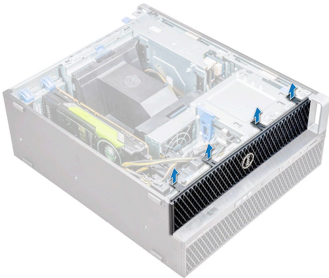
(b) סובב את המסגרת קדימה, הרם והוצא את המסגרת הקדמית מהמערכת.
