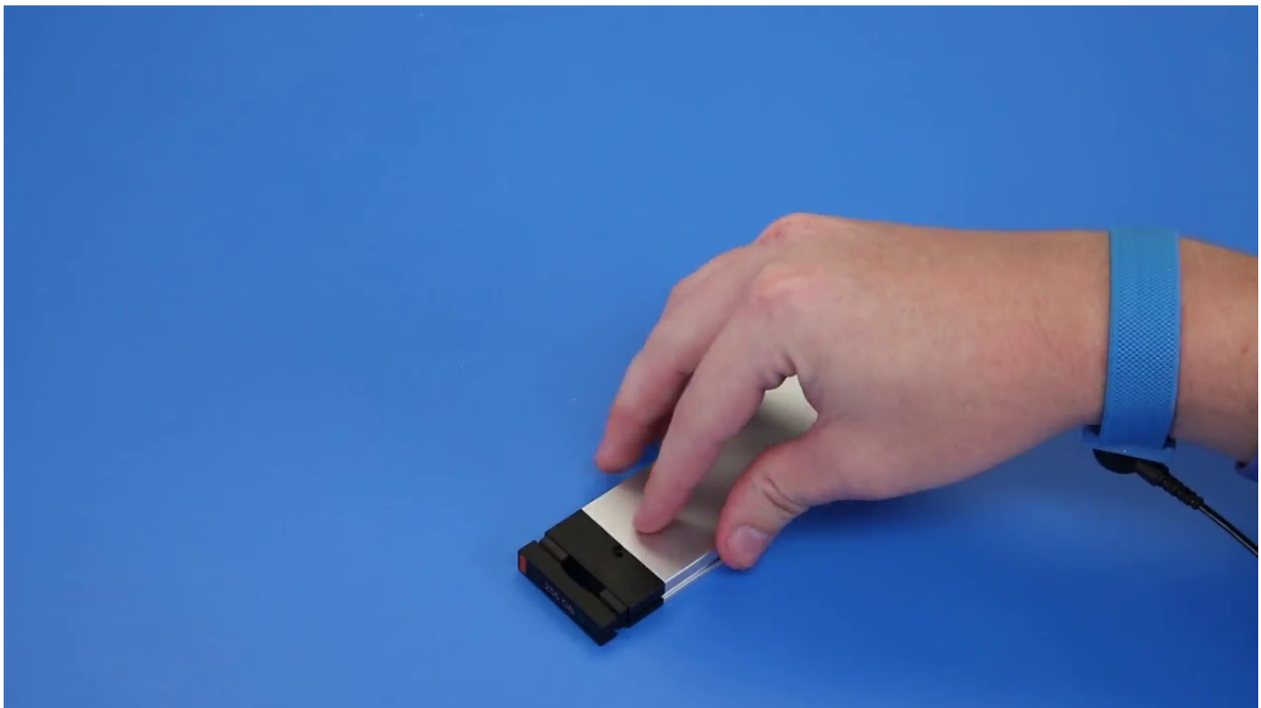
(d) החלק את ה-SSD והוצא אותו מחריץ ה-M.2 על הנשא.
