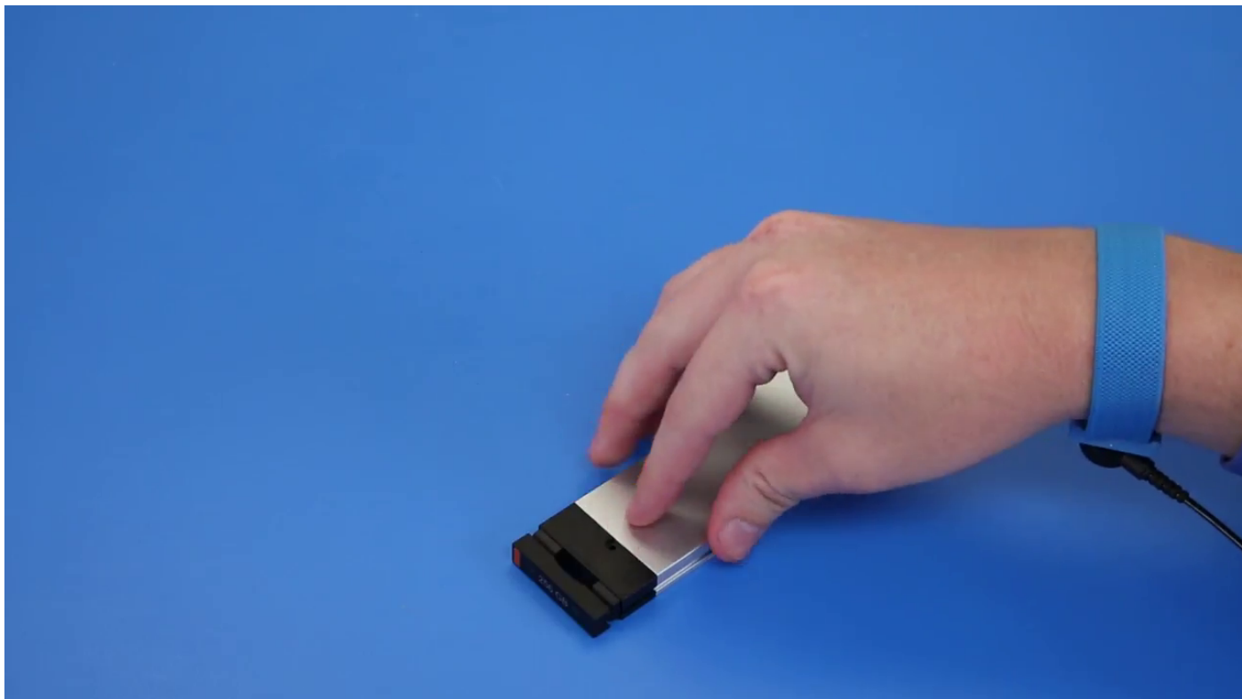
d) Skub SSD-dækslet ud af M.2-slotten på holderen.
