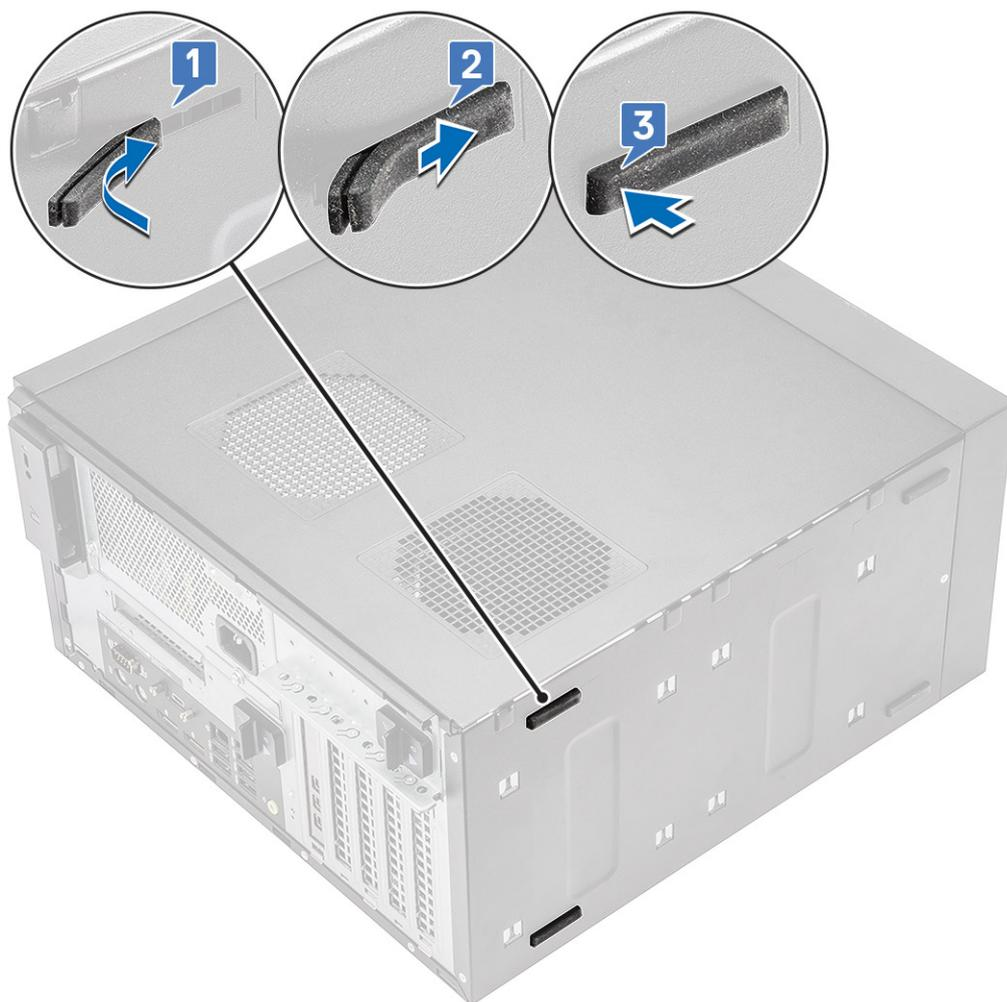
**Abbildung 15. Anbringen der hinteren GummifüÙe**
