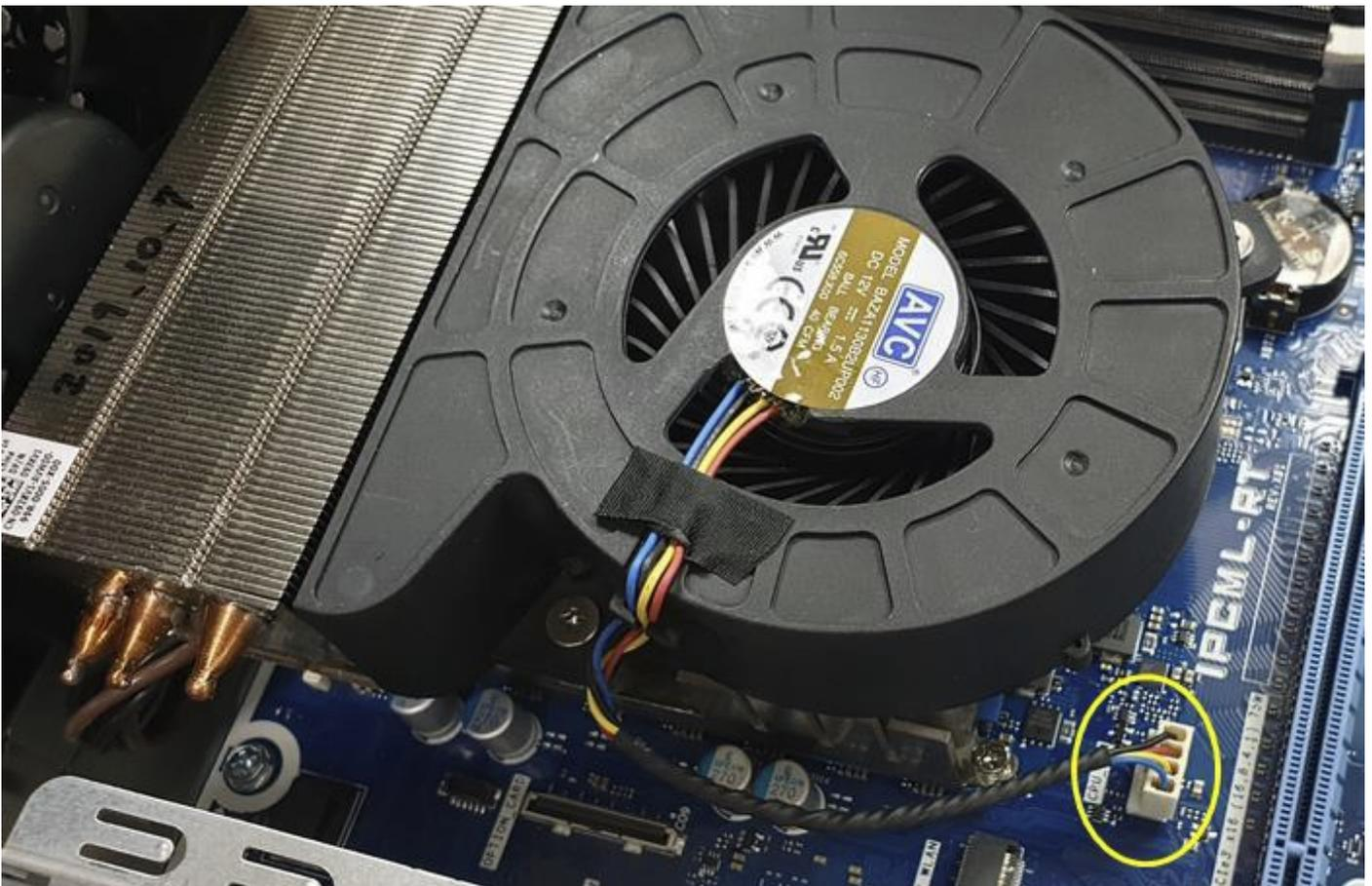
Abbildung 7. Kühlkörperbaugruppe – 125 W CPU
