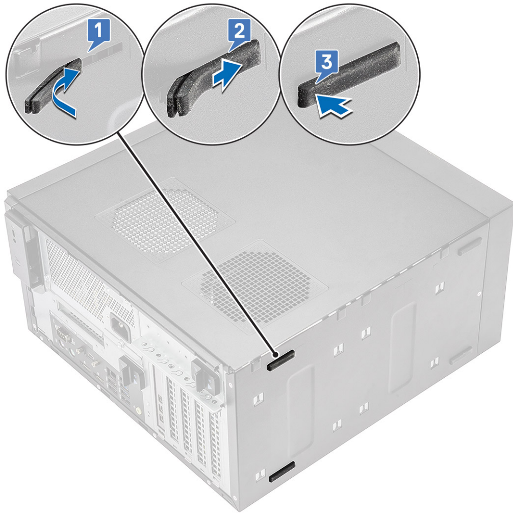
그림 15 . 후면 고무 받침 설치
