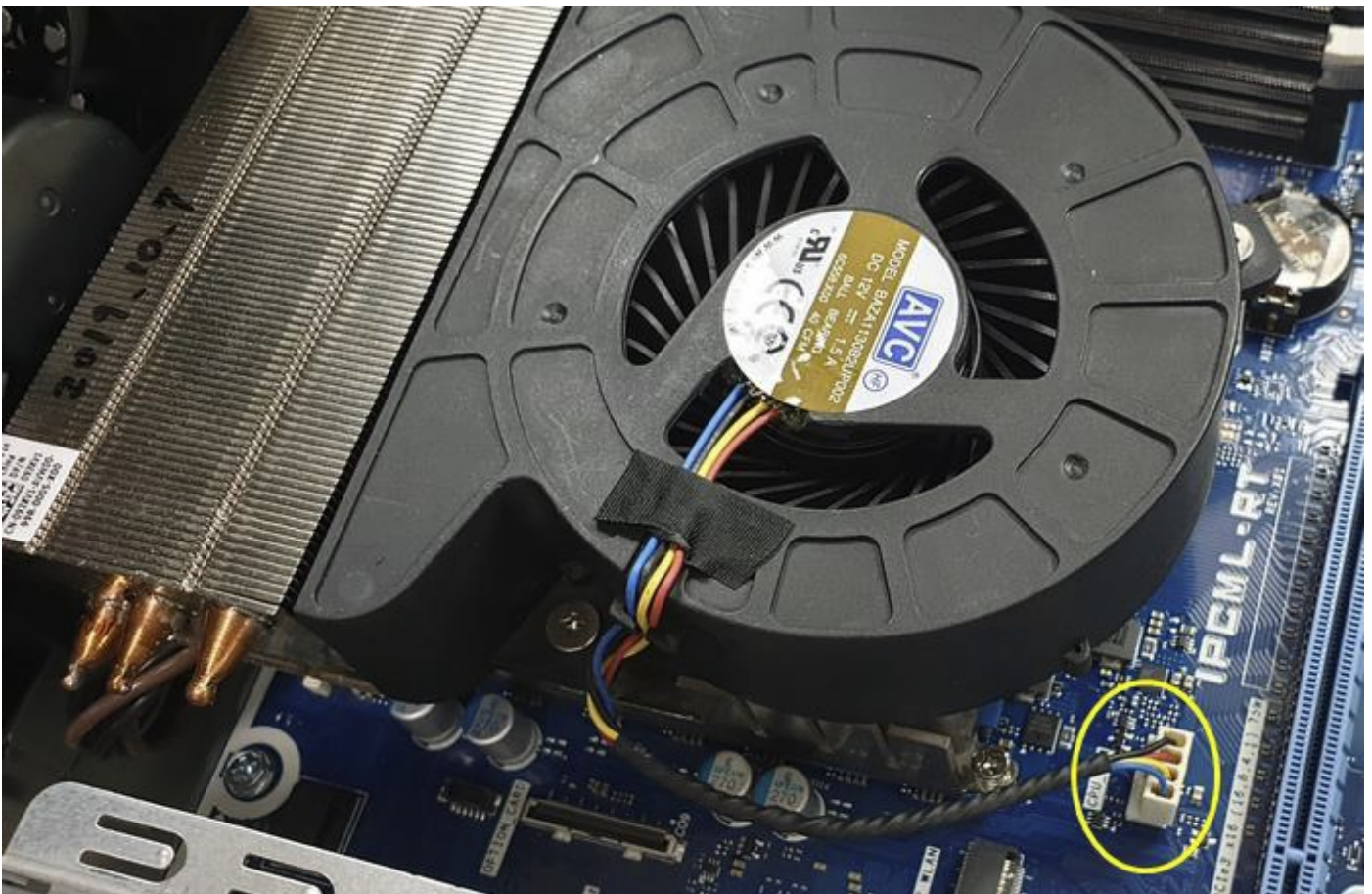
រូប 7. គ្រឿងដំឡើងកម្ដៅកណ្តាល - 125 W CPU
