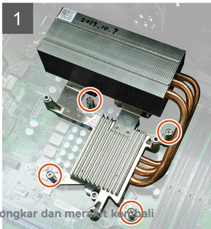
Angka 5. Rakitan unit pendingin - CPU 125 W
