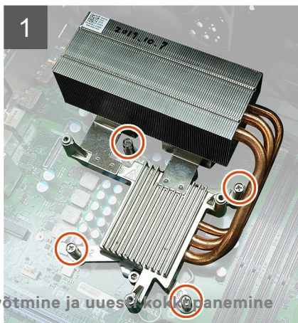
Joonis 5. Jahutusradiaatori koost – 125 W protsessor
