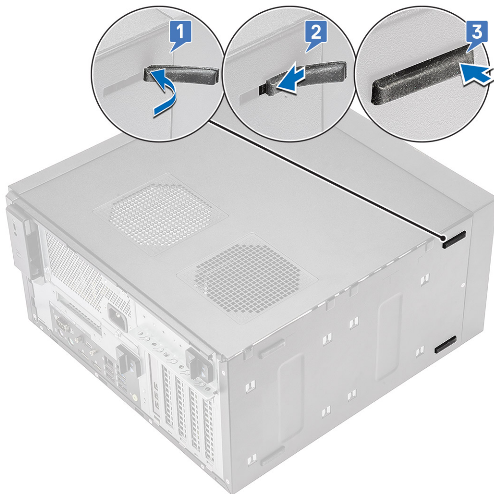
Ilustración 14. Instalación de los pies de goma frontales
