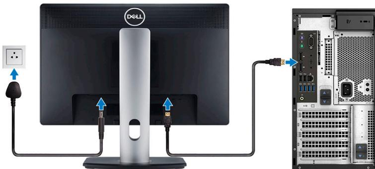
**i** **メモ:** 外付けグラフィックスカード搭載のコンピュータを注文した場合、コンピュータの背面パネルの HDMI ポートとディスプレイポートはカバーされています。外付けグラフィックスカードに、ディスプレイを接続します。
