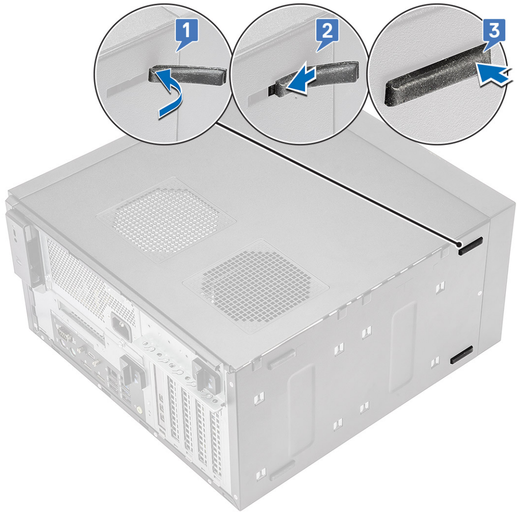
그림 6. 전면 고무 다리 설치
