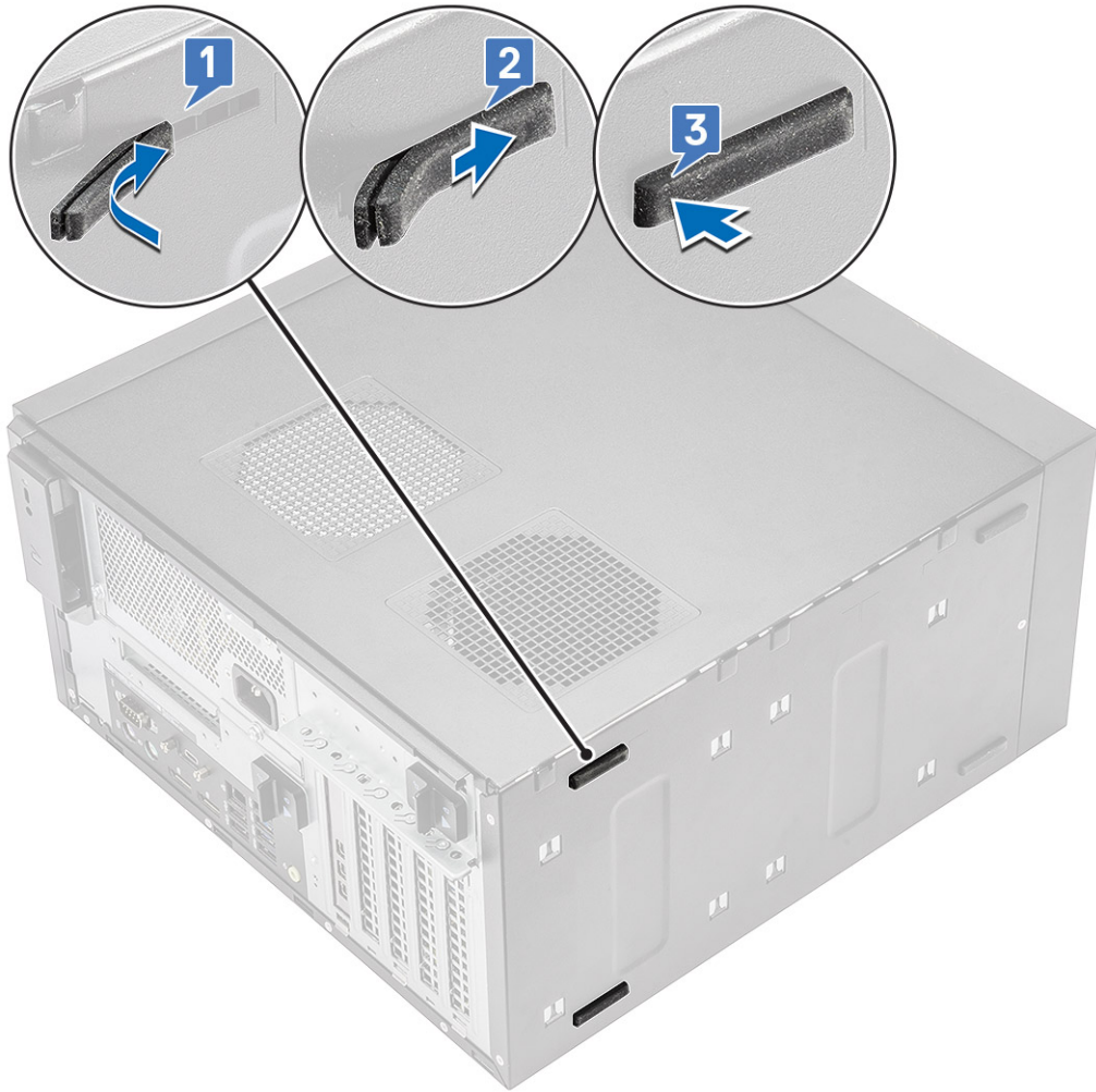
그림 7. 후면 고무 받침 설치
