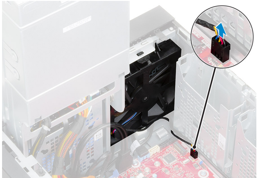
5. لتحرير المروحة الأمامية من الدعامة، ادفع اللسان الذي يثبت المروحة الأمامية إلى الدعامة.
