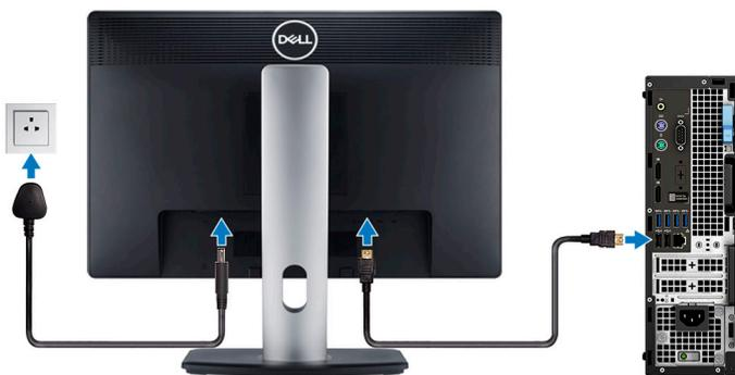
**メモ:** 外付けグラフィックスカード搭載のコンピュータを注文した場合、コンピュータの背面パネルの HDMI ポートとディスプレイポートはカバーされています。ディスプレイを外付けグラフィックスカードに接続してください。
