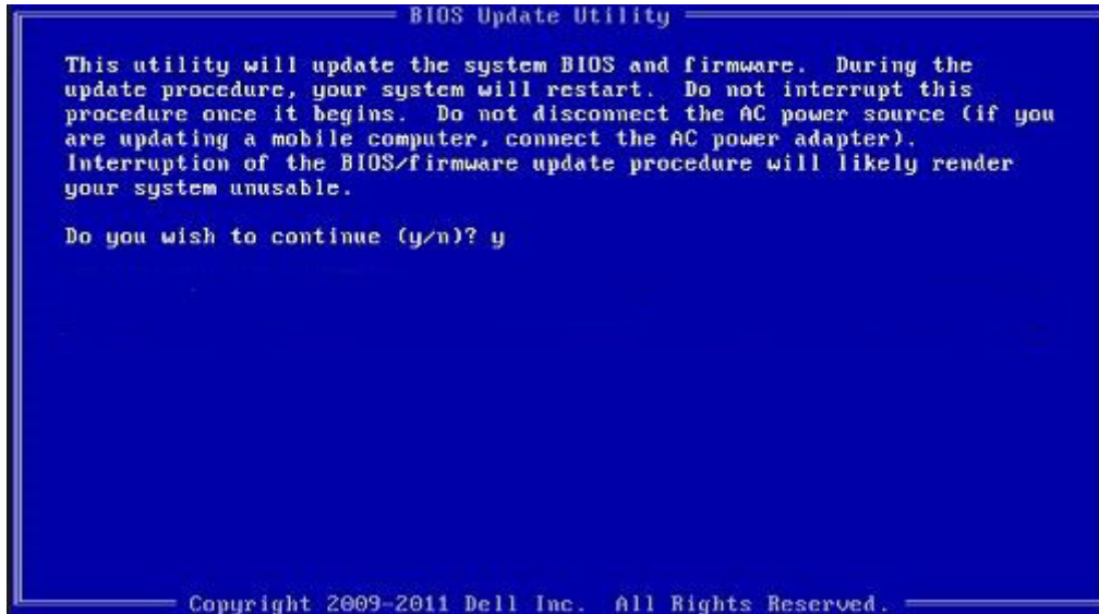
شكل 1. شاشة تحديث نظام الإدخال/الإخراج الأساسي (BIOS) عبر نظام تشغيل الأقراص (DOS)
