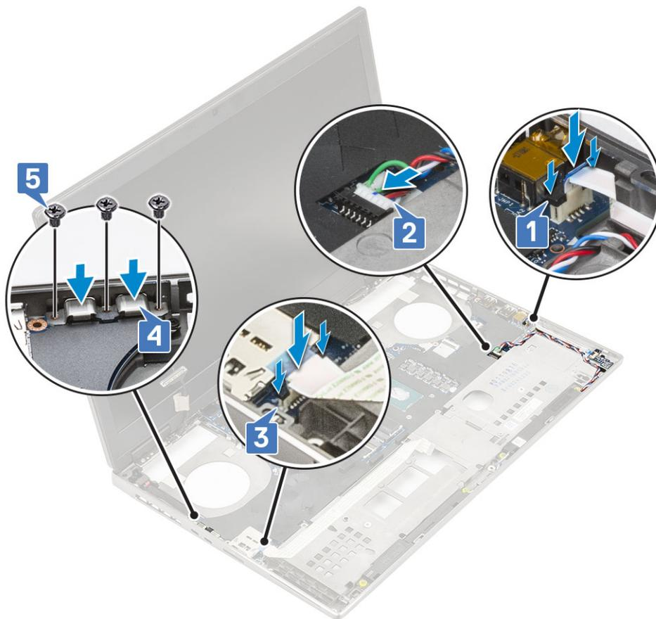
f) Ligue o cabo do conector de alimentação e o cabo da bateria aos conectores na placa de sistema [1, 2].
