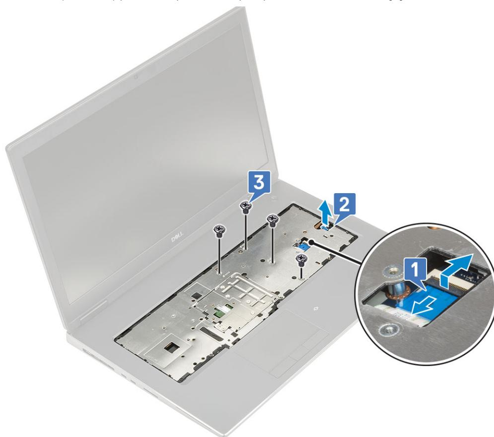
e) Pressione o orifício na base do sistema para libertar o apoio para as mãos do chassi inferior.
