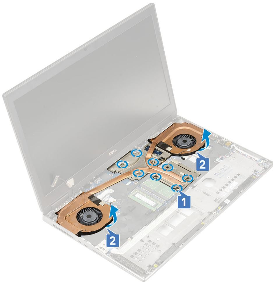
h) Deslize e retire o conjunto do dissipador de calor do sistema.
