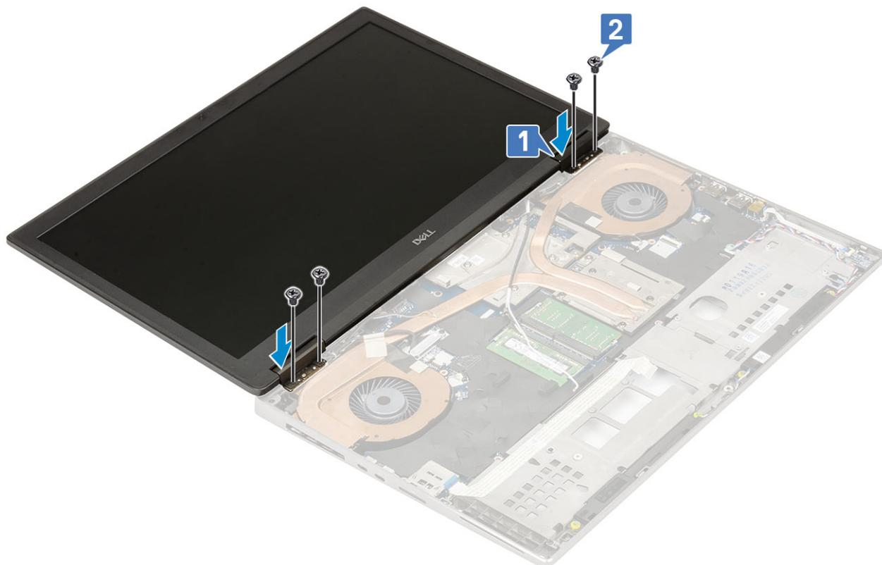
g) Chiudere il gruppo del display e ricollocare le 2 viti (M2.5x6.0) sul retro del sistema per fissare il gruppo del display in posizione.
