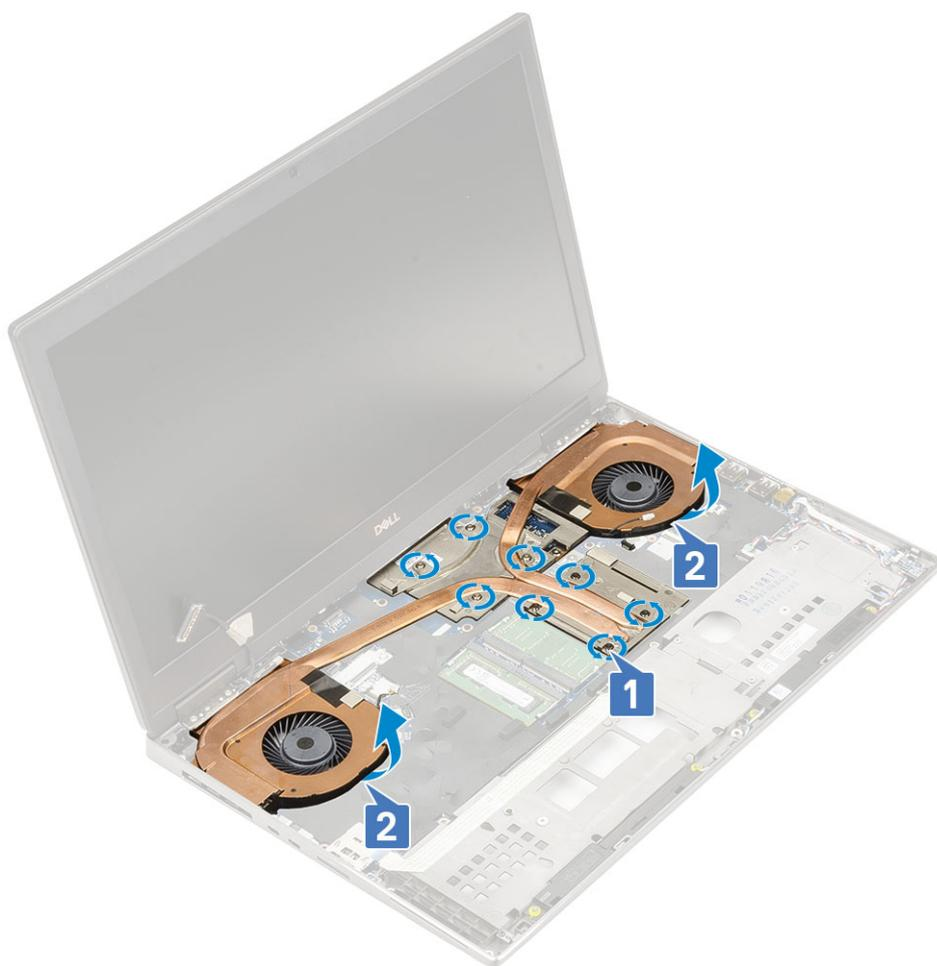
h) Faites glisser l'assemblage du dissipateur de chaleur pour le retirer du système.
