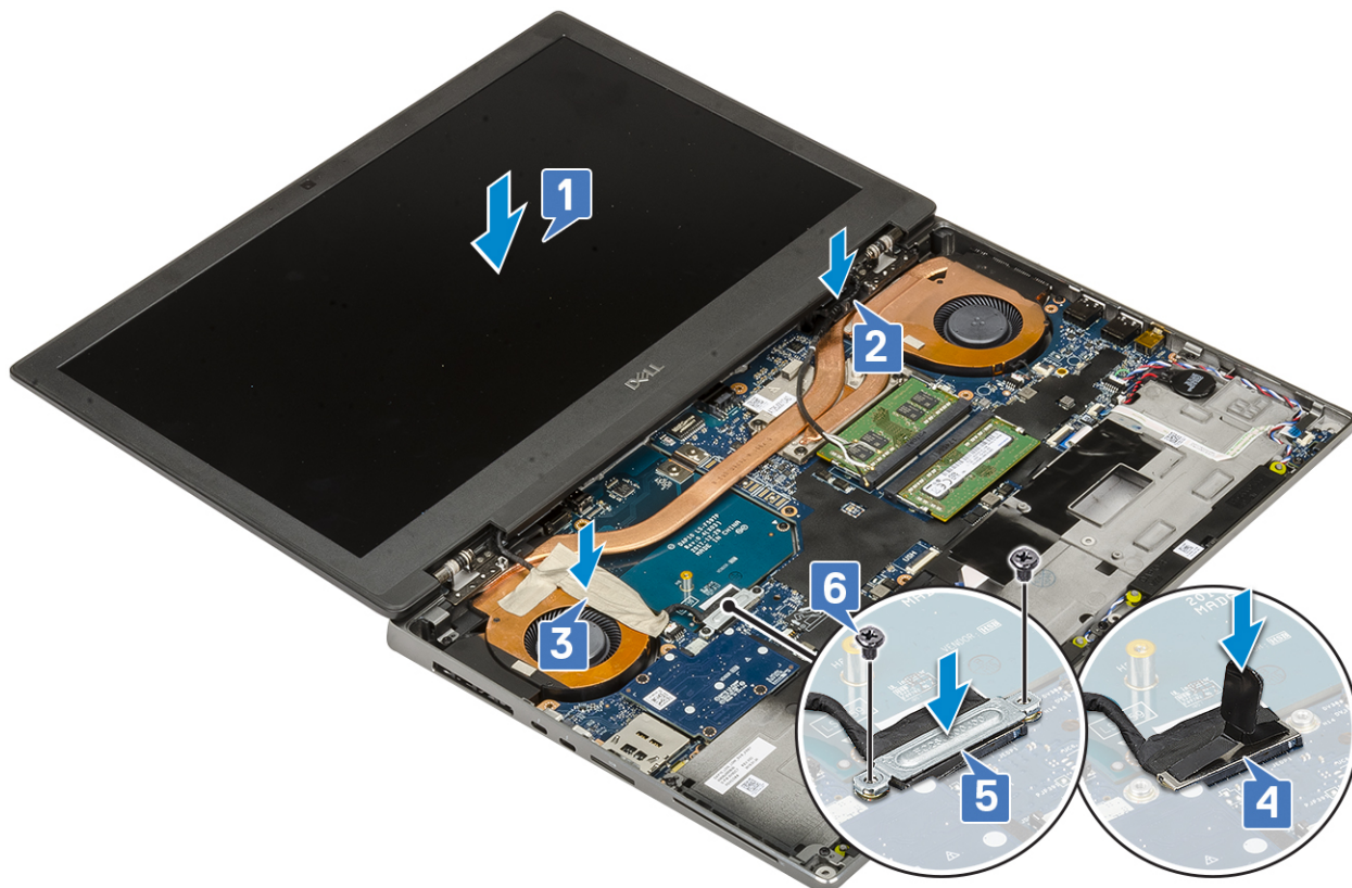
f) [הברגים כדי להדק את מכסי צירי הצג למערכת [1, 2] (M2.5x4.0) ישר את מכסי צירי הצג והברג חזרה את 4
