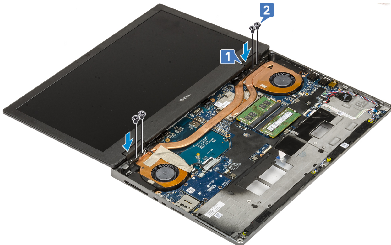
g) הברגים בחלקה האחורי של המערכת כדי להדק את מכלול הצג למקומו (M2.5x6.0) סגור את מכלול הצג והברג חזרה את 2
