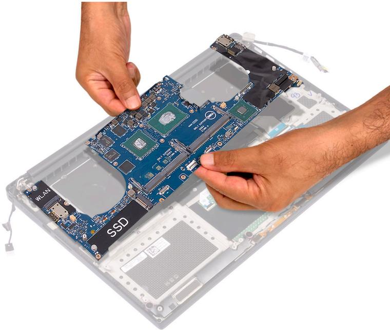
4. 電源アダプターポートケーブル、スピーカーケーブル、キーボードコントロールボードケーブル、タッチパッドケーブル、タッチスクリーンケーブルをシステムボードに接続します。
